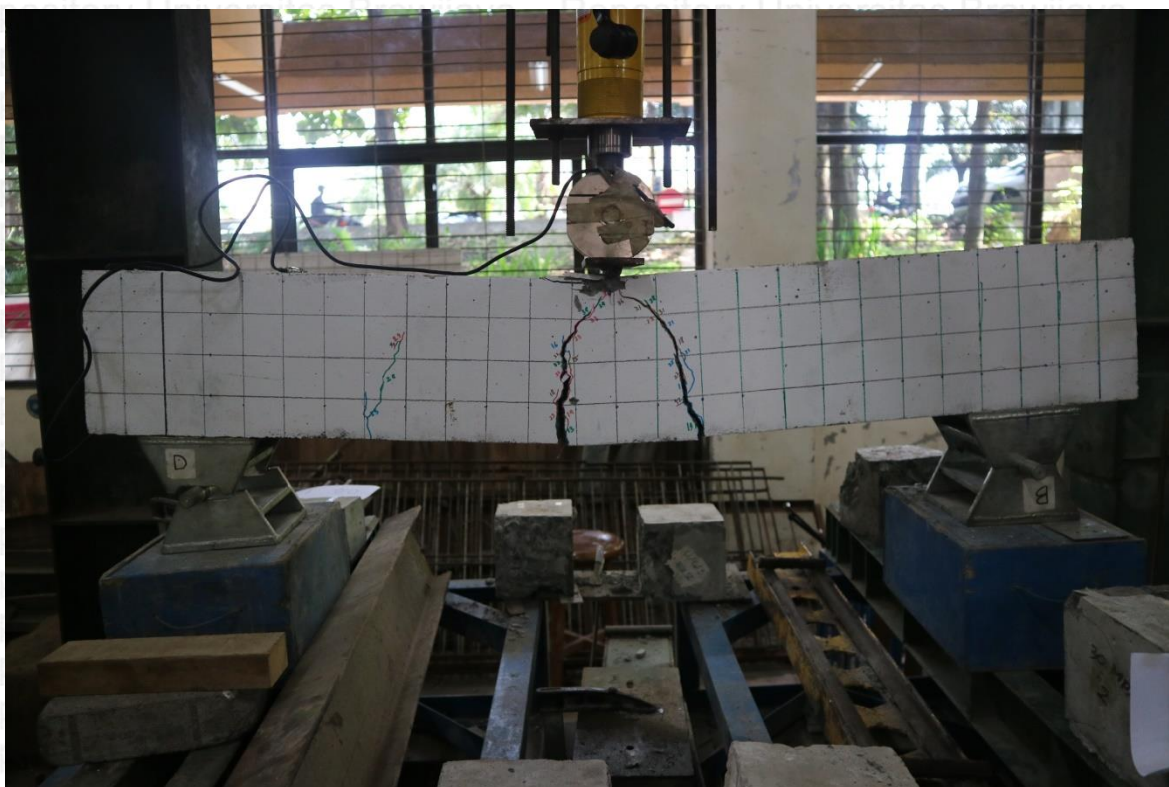
Gambar 1. Pola Retak Benda Uji I,0,6.1
