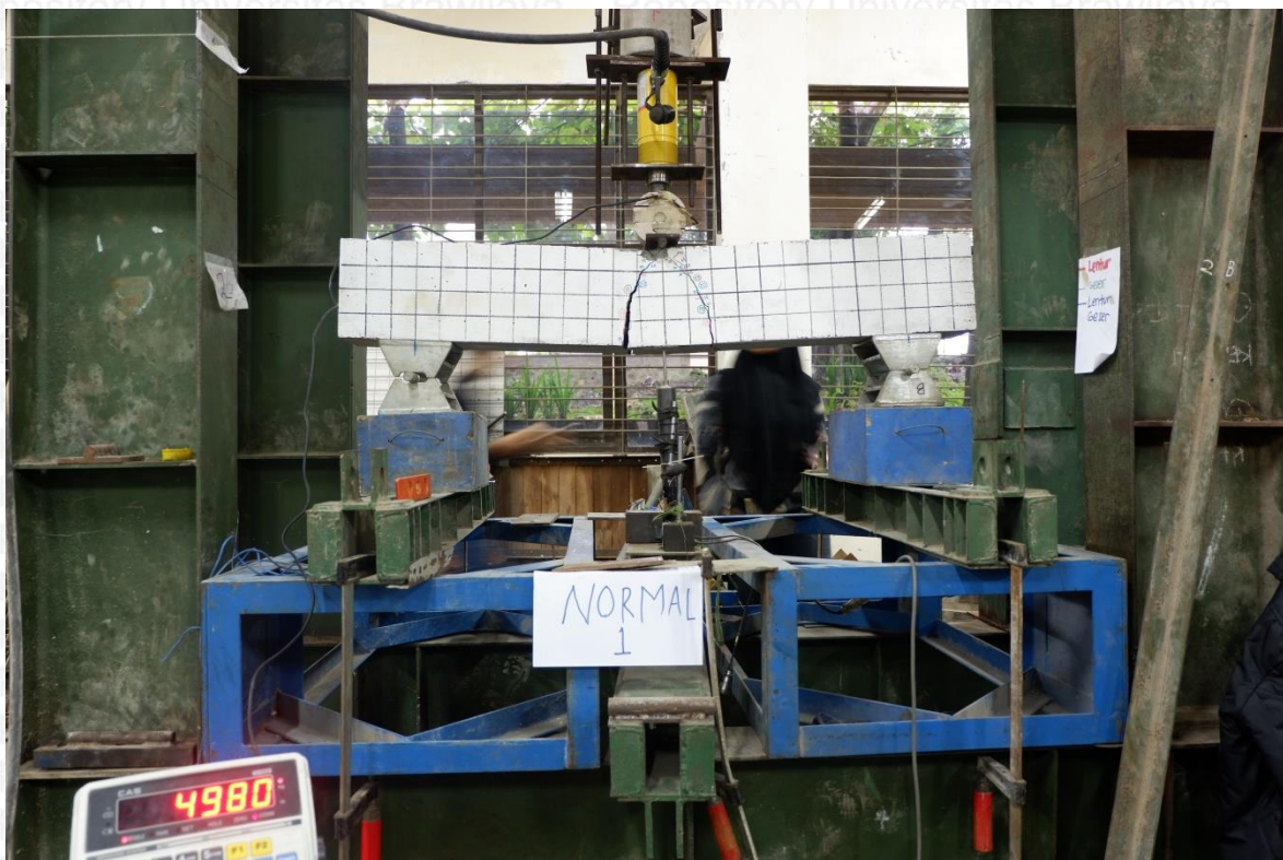
Gambar 10. Pola Retak Benda Uji Normal 1
