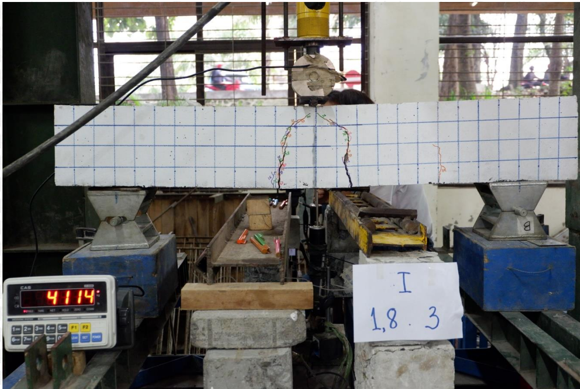
Gambar 9. Pola Retak Benda Uji I.1,8.3
