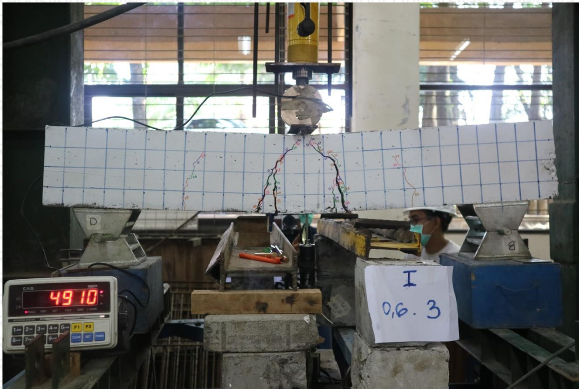
Gambar 3. Pola Retak Benda Uji I.0,6.3
