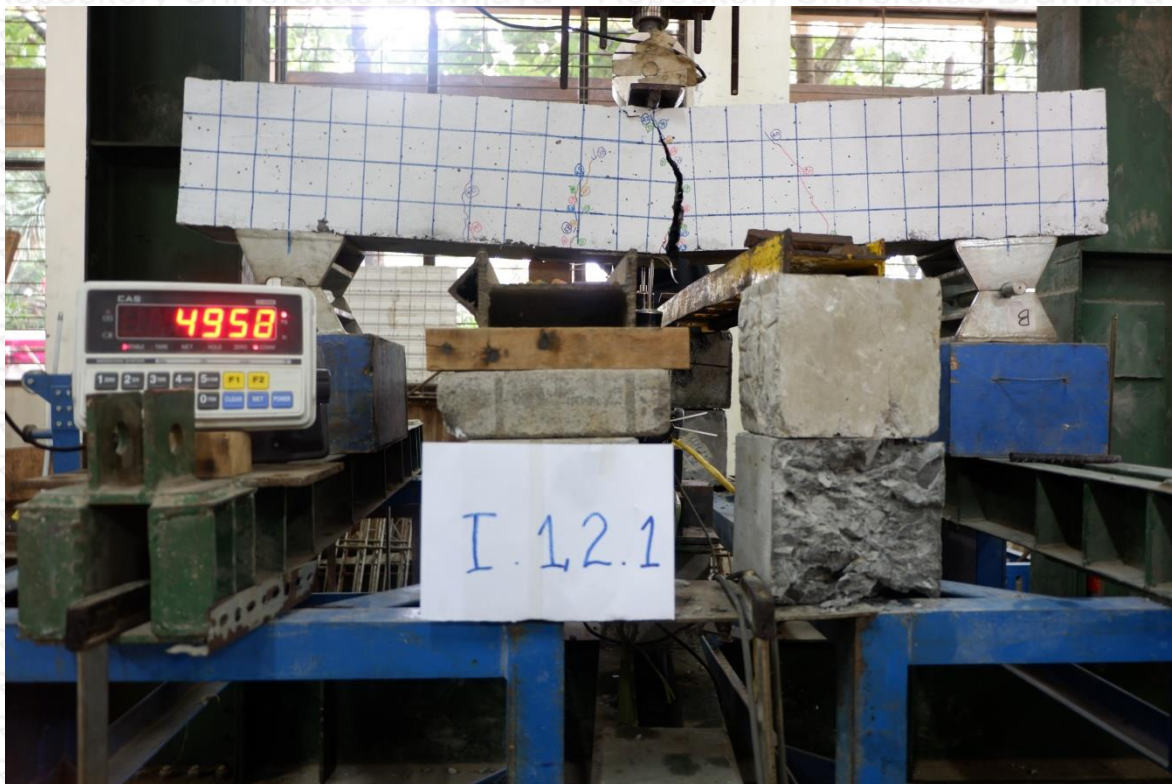
Gambar 4. Pola Retak Benda Uji I.1,2.1
