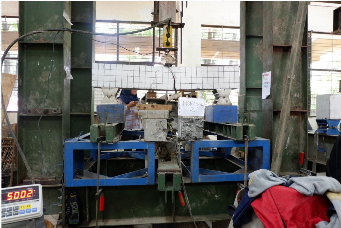
Gambar 11. Pola Retak Benda Uji Normal 2
