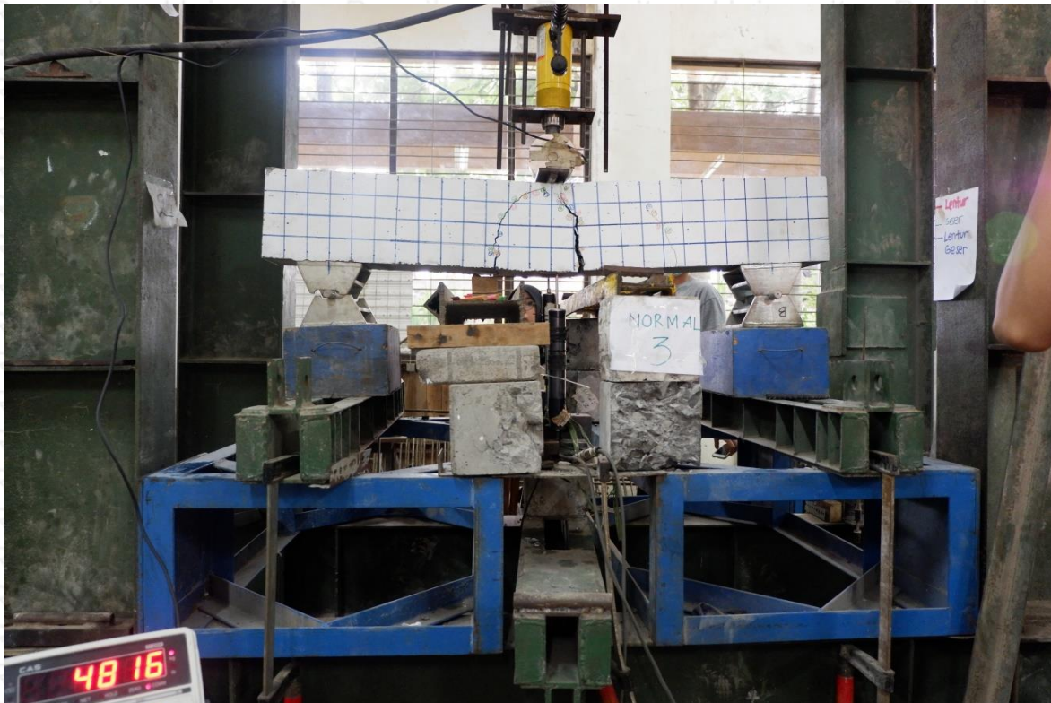
Gambar 12. Pola Retak Benda Uji Normal 3
