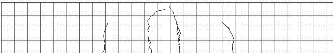
Gambar 12. Tampak Belakang Pola Retak Benda Uji I.1,2,2
