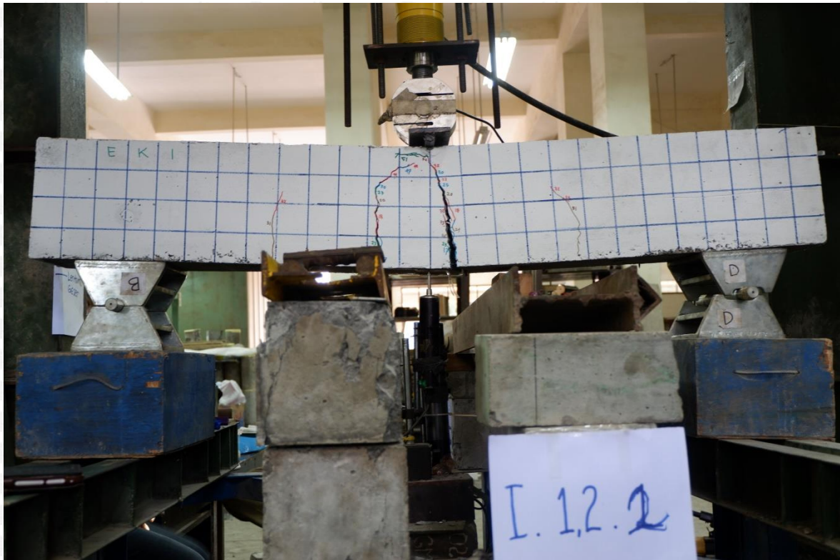
Gambar 5. Pola Retak Benda Uji I.1,2,2
