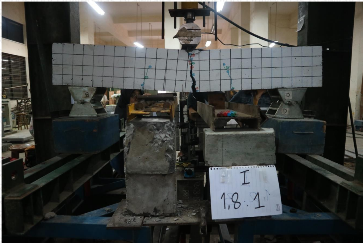
Gambar 7. Pola Retak Benda Uji I.1,8.1
