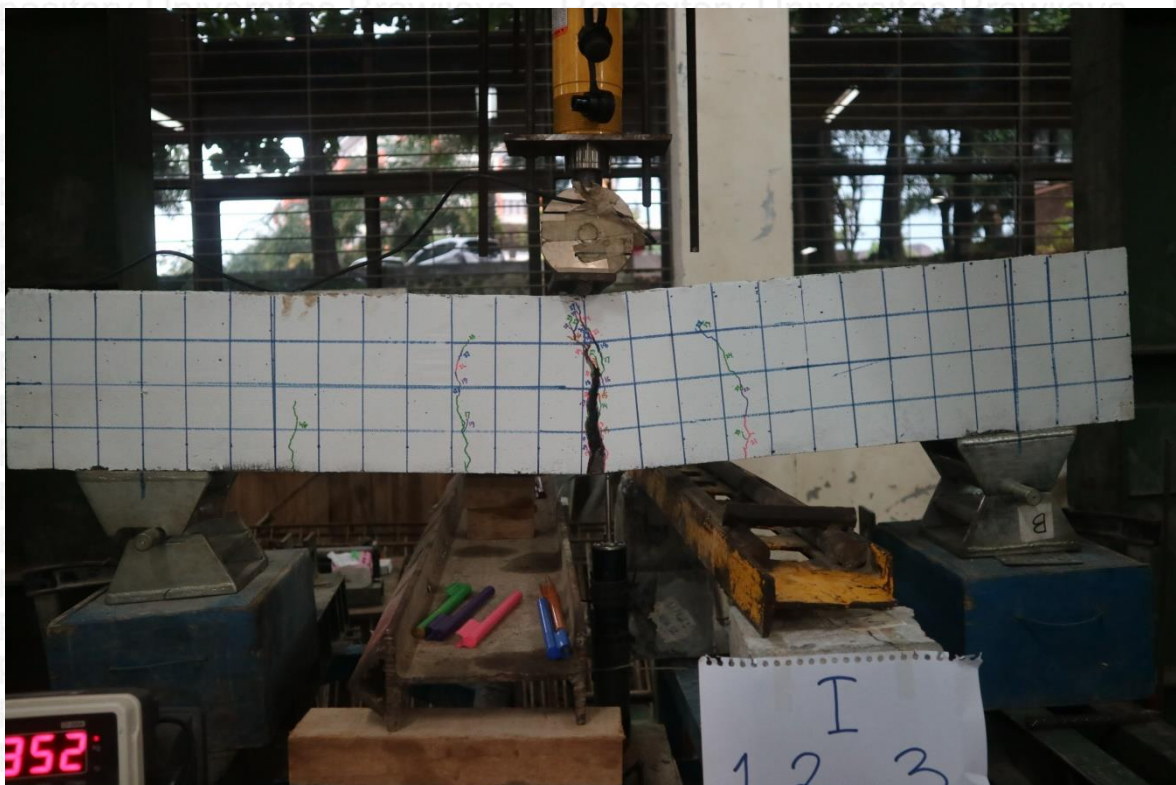
Gambar 6. Pola Retak Benda Uji I.1,2,3
