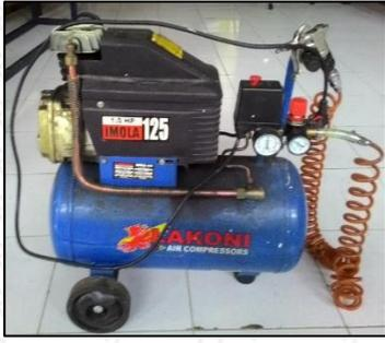
Gambar 3.2 kompresor Udara
