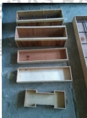
Gambar 5. 15 Cetakan spesimen benda uji beton serat kinerja tinggi
