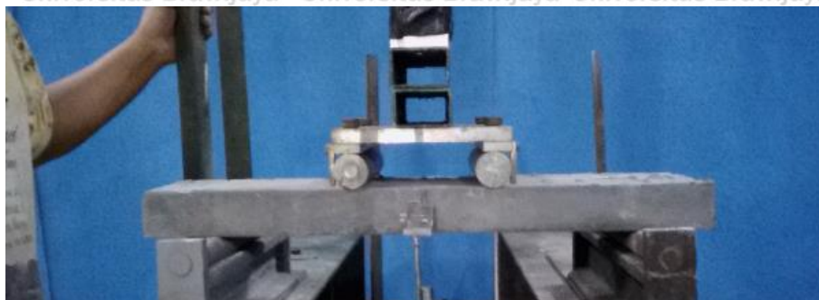
Gambar 5.30 Setting pengujian lentur spesimen pelat dengan metode three-point loading
