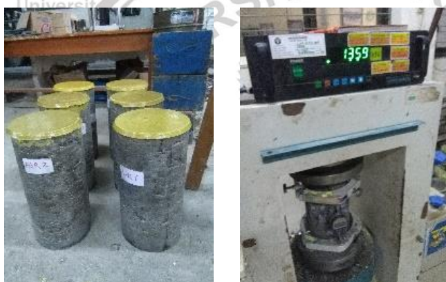
Gambar 5. 12 Pengujian kuat tekan dengan variasi kadar silika fume
