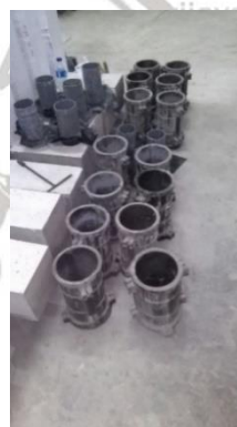
Gambar 5. 15 Cetakan spesimen benda uji beton serat kinerja tinggi
