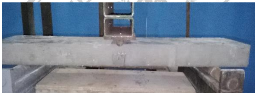
Gambar 5. 29 Setting pengujian lentur spesimen pelat dengan metode center-point loading
