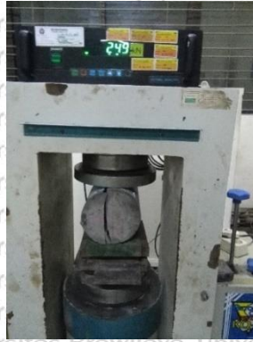
Gambar 5. 23 Uji tarik belah silinder beton kinerja tinggi
