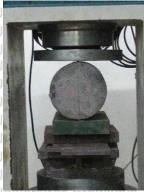
Gambar 5. 23 Uji tarik belah silinder beton kinerja tinggi
