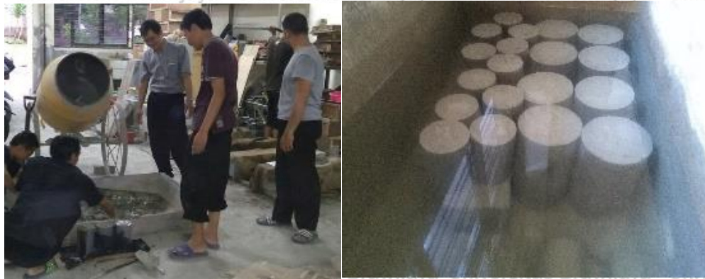
Gambar 5.7. Pengecoran dan perawatan benda uji beton
