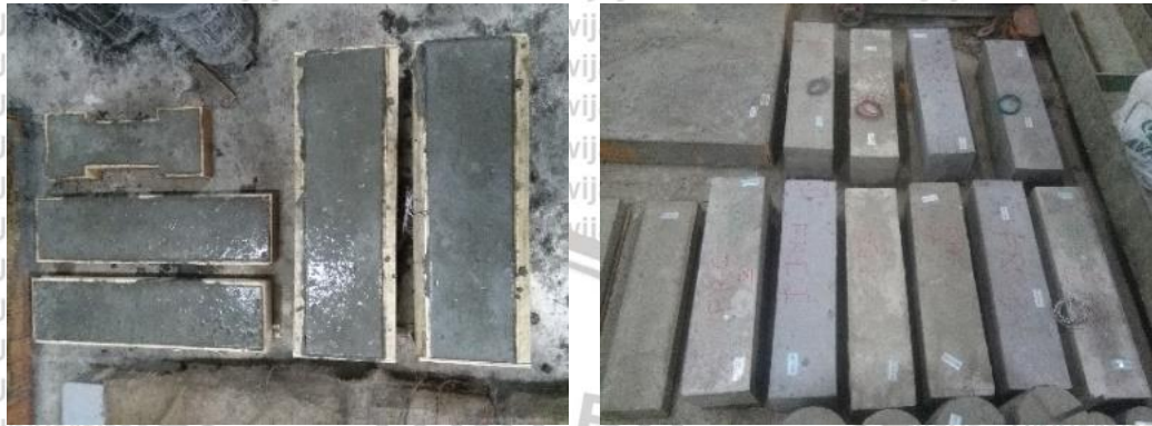
Gambar 5.18 Pembuatan spesimen beton serat kinerja tinggi
