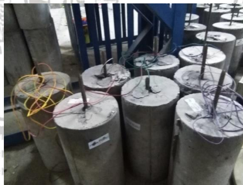
Gambar 5. 25 Uji tarik cabut ( Pullout Test ) silinder beton serat kinerja tinggi
