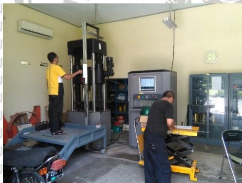
Gambar 5. 31 Uji tarik baja tulangan dengan alat Static-Hydraulic Universal Test Systems MTS.
