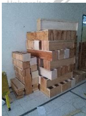
Gambar 5. 15 Cetakan spesimen benda uji beton serat kinerja tinggi
