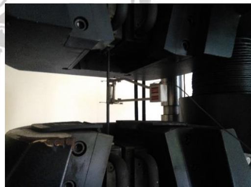
Gambar 5. 31 Uji tarik baja tulangan dengan alat Static-Hydraulic Universal Test Systems MTS.
