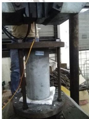
Gambar 5. 25 Uji tarik cabut ( Pullout Test ) silinder beton serat kinerja tinggi
