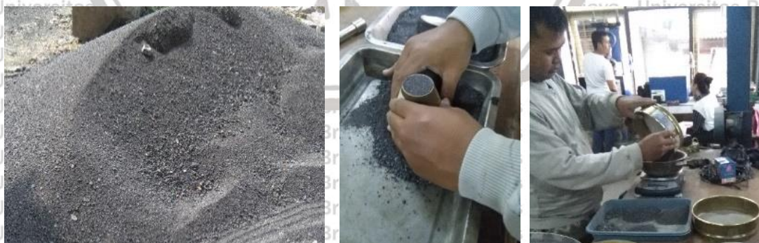
Gambar 5.1 Pengujian kondisi SSD dan analisis saringan agregat halus
