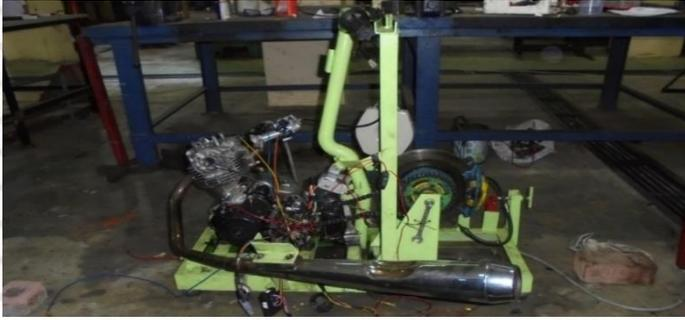
Gambar 4.1 Motor bakar 6 langkah
