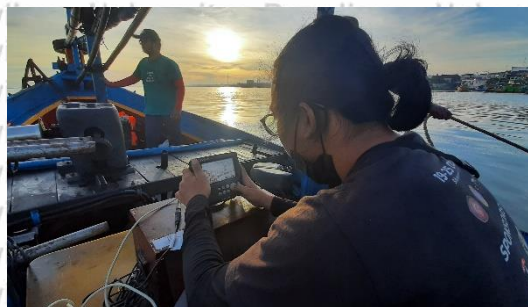
Proses Pemasangan dan Perakitan Singlebeam Echosounder
