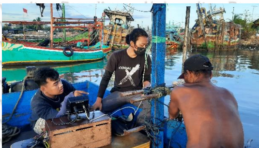
Proses Pemasangan dan Perakitan Singlebeam Echosounder
