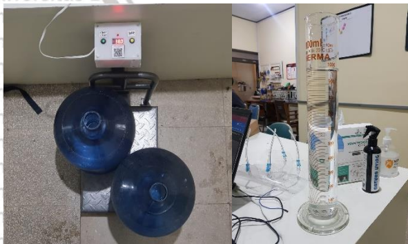
Gambar 4.5 Sensor Load Cell dikalibrasi menggunakan massa air sebagai kalibrator
