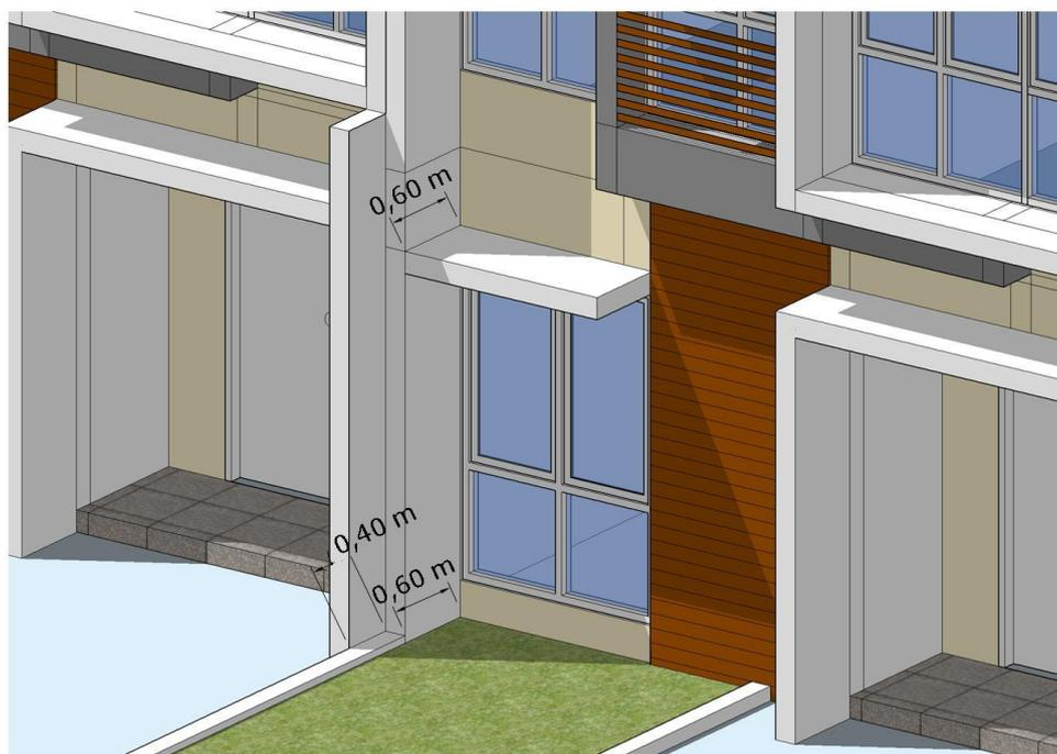
Gambar 4.22 Detail Eksisting Shading Bangunan Orientasi Cenderung Timur (1,2 dan 3)
