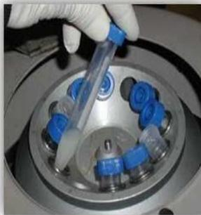
Disentrifugasi dengan kecepatan 3500 rpm selama 20 menit
