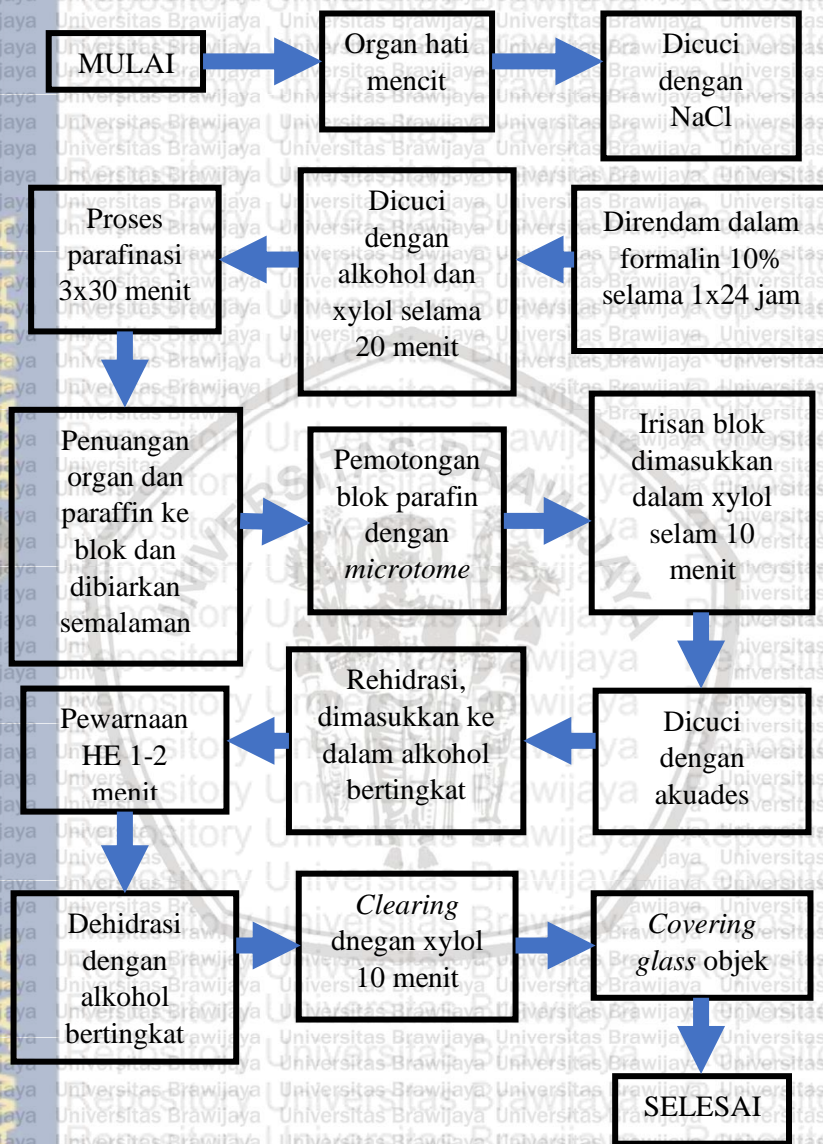
Gambar 3.4 Diagram alir proses pembuatan preparat organ hati
