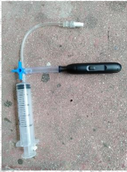
Seperangkat alat paparan (tabung spuit, rokok elektrik, selang dan three way )
