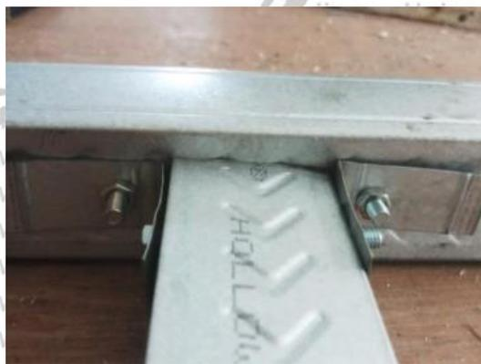
Detail sambungan pada benda uji portal.
