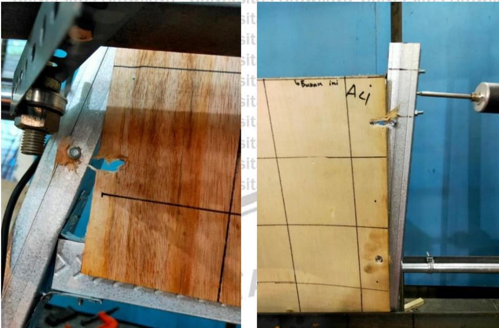
Gambar 4.16 Kegagalan sobek pada panel dinding di bagian sambungan.
