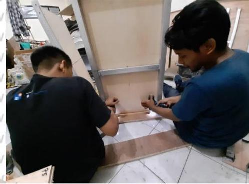
Memotong ujung kolom sepanjang 8 cm untuk dibengkokkan sehingga akan menjadi sambungan antara kolom dengan alas multiplek.
