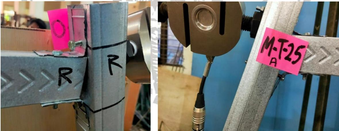
Gambar 4.15 Kegagalan sambungan baut pada balok kolom.
