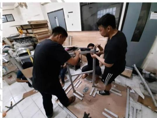
Merangkai benda uji dengan bantuan mal (cetakan) dilanjutkan dengan pemasangan sambungan pada tiap joinnya.
