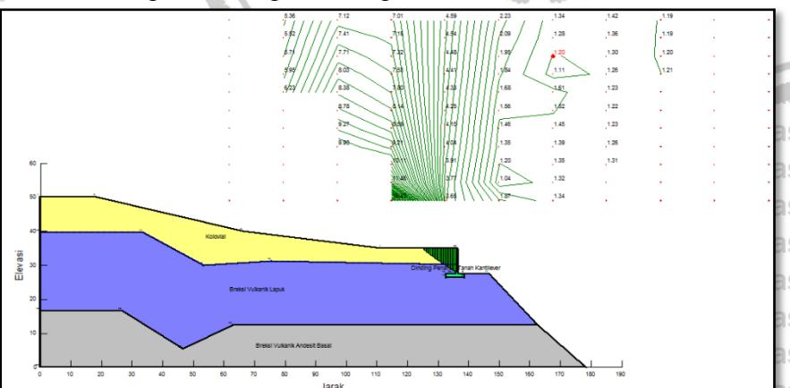
Gambar 4.36. Nilai Analisis Faktor Keamanan Lereng Alternatif 2 Dinding Penahan Tanah Kantilever Pada Kondisi Tanpa Gempa
