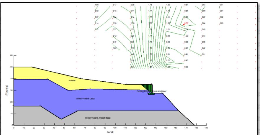
Gambar 4.41. Nilai Analisis Faktor Keamanan Lereng Alternatif 2 Dinding Penahan Tanah Kantilever Pada Kondisi Akibat Gempa
