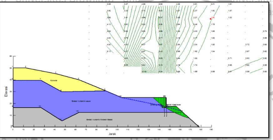
Gambar 4.16. Nilai Analisis Faktor Keamanan Lereng Alternatif 3 Dinding Penahan Tanah Kantilever Dengan *Bored Pile* Pada Kondisi Tanpa Gempa
