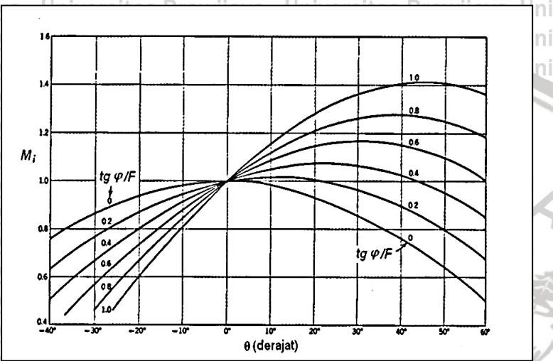
*Gambar 2.15* Diagram Untuk Menentukan  $M_i$ , (Janbu, 1956)
