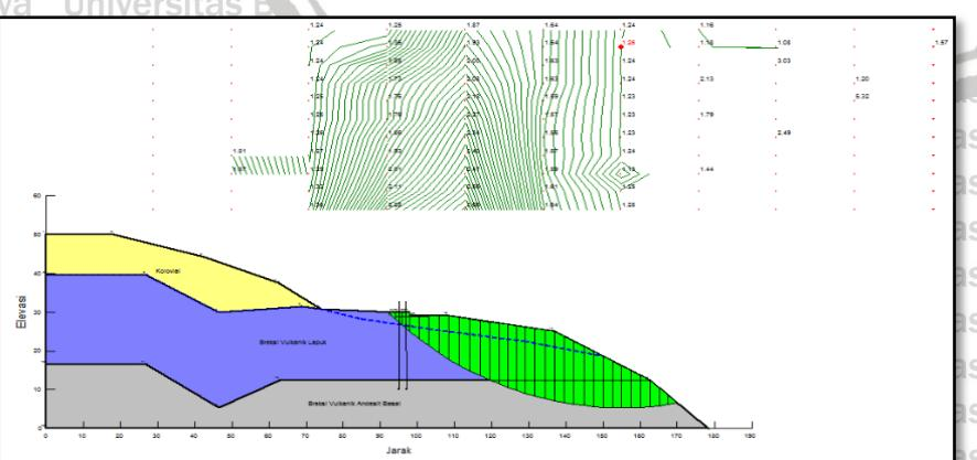
Gambar 4.29. Nilai Analisis Faktor Keamanan Lereng Alternatif 1 Bored Pile Pada Kondisi Akibat Gempa
