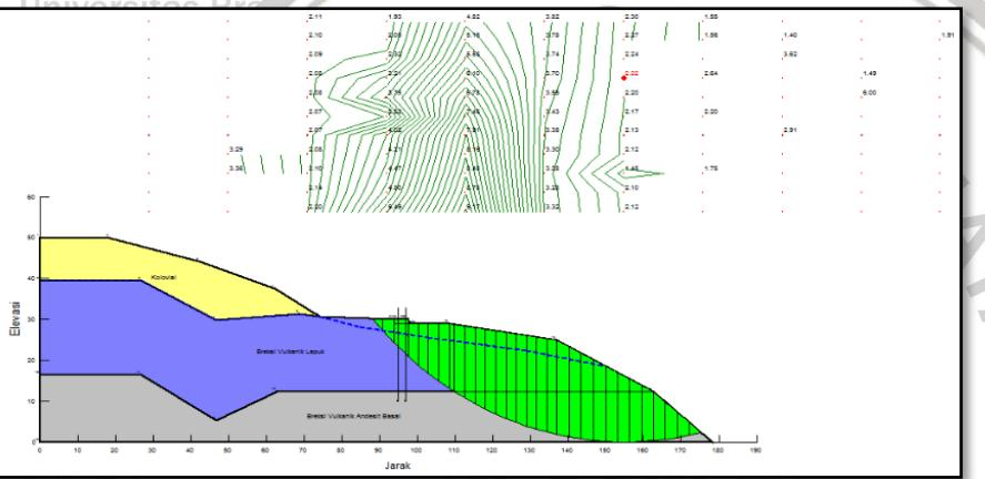
*Gambar 4.24.* Nilai Analisis Faktor Keamanan Lereng Alternatif 1 *Bored Pile* Pada Kondisi Tanpa Gempa
