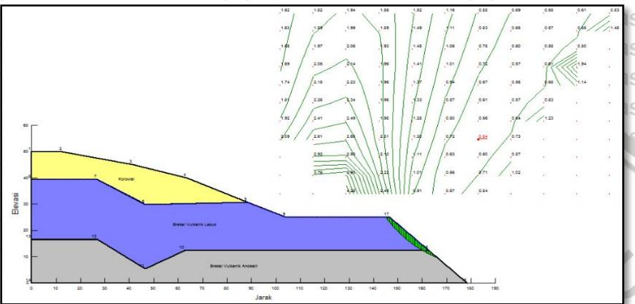
*Gambar 4.7.* Analisis Faktor Keamanan Lereng pada Kondisi Dengan Gempa Kelongsoran pada Cross STA 0+075
