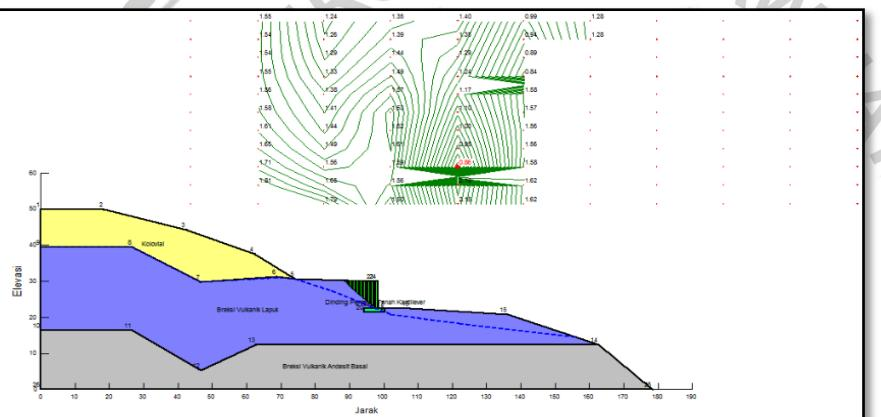
*Gambar 4.30.* Nilai Analisis Faktor Keamanan Lereng Alternatif 2 Dinding Penahan Tanah Kantilever Pada Kondisi Akibat Gempa
