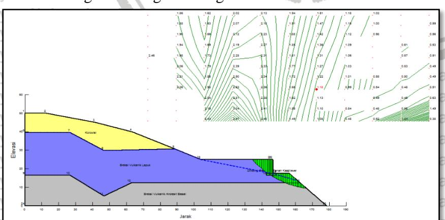
Gambar 4.20. Nilai Analisis Faktor Keamanan Lereng Alternatif 2 Dinding Penahan Tanah
