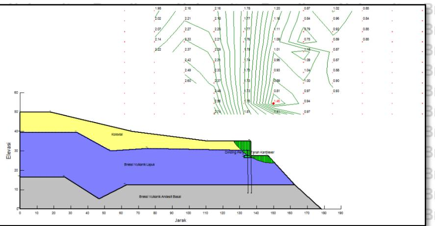
Gambar 4.42. Nilai Analisis Faktor Keamanan Lereng Alternatif 3 Dinding Penahan Tanah Kantilever Dengan *Bored Pile* Pada Kondisi Akibat Gempa
