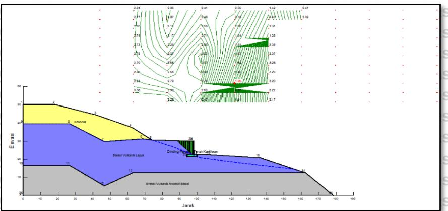
Gambar 4.25. Nilai Analisis Faktor Keamanan Lereng Alternatif 2 Dinding Penahan Tanah Kantilever Pada Kondisi Tanpa Gempa
