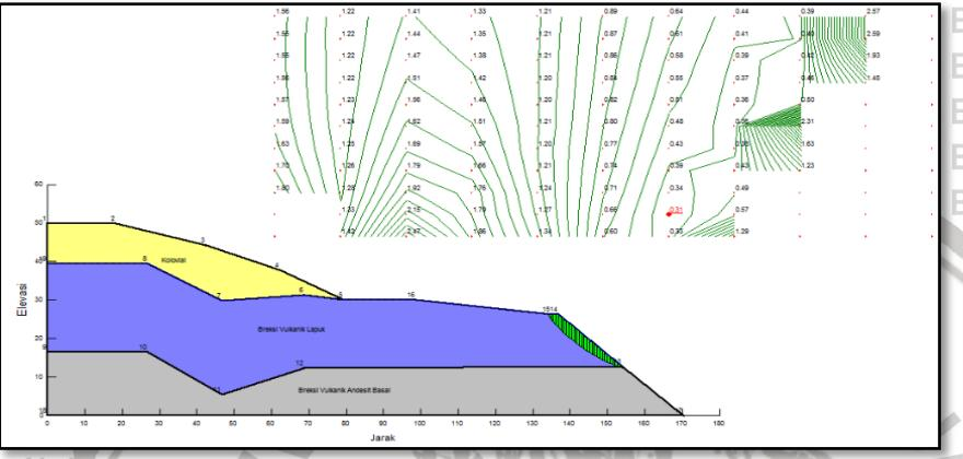
**Gambar 4.9.** Analisis Faktor Keamanan Lereng pada Kondisi Akibat Gempa Kelongsoran pada Cross STA 0+125
