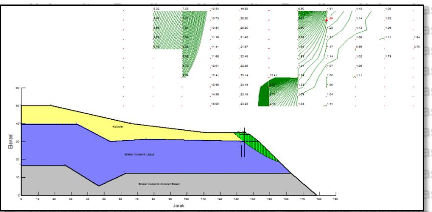
Gambar 4.35. Nilai Analisis Faktor Keamanan Lereng Alternatif 1 *Bored Pile* Pada Kondisi
