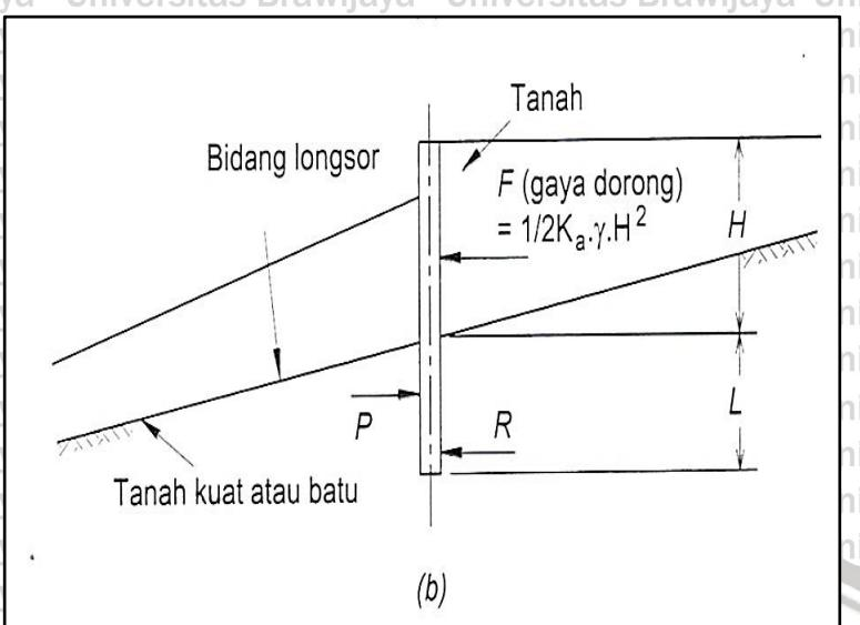
Gambar 2.24 Konsep Perancangan Dinding dari Tiang Bor
