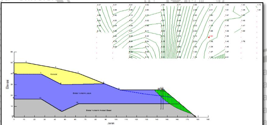
*Gambar 4.14.* Nilai Analisis Faktor Keamanan Lereng Alternatif 1 Bored Pile Pada Kondisi Tanpa Gempa
