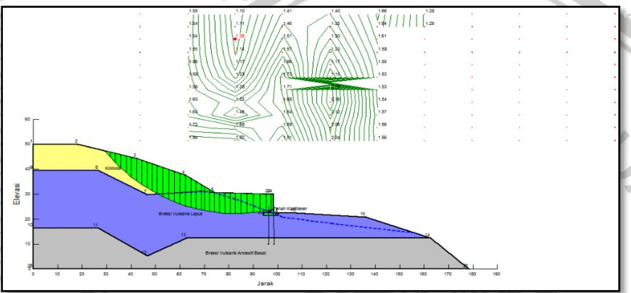
Gambar 4.31. Nilai Analisis Faktor Keamanan Lereng Alternatif 3 Dinding Penahan Tanah Kantilever Dengan *Bored Pile* Pada Kondisi Akibat Gempa
