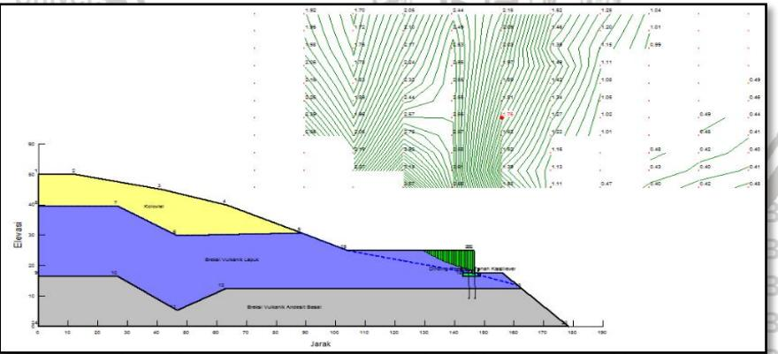
*Gambar 4.21.* Nilai Analisis Faktor Keamanan Lereng Alternatif 3 Dinding Penahan Tanah Kantilever Dengan *Bored Pile* Pada Kondisi Akibat Gempa
