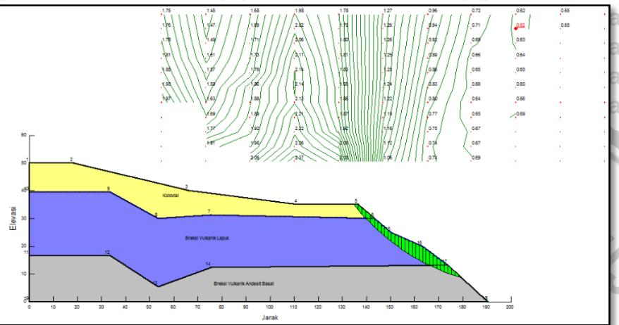
*Gambar 4.11.* Analisis Faktor Keamanan Lereng pada Kondisi Akibat Gempa Kelongsoran pada Cross STA 0+175
