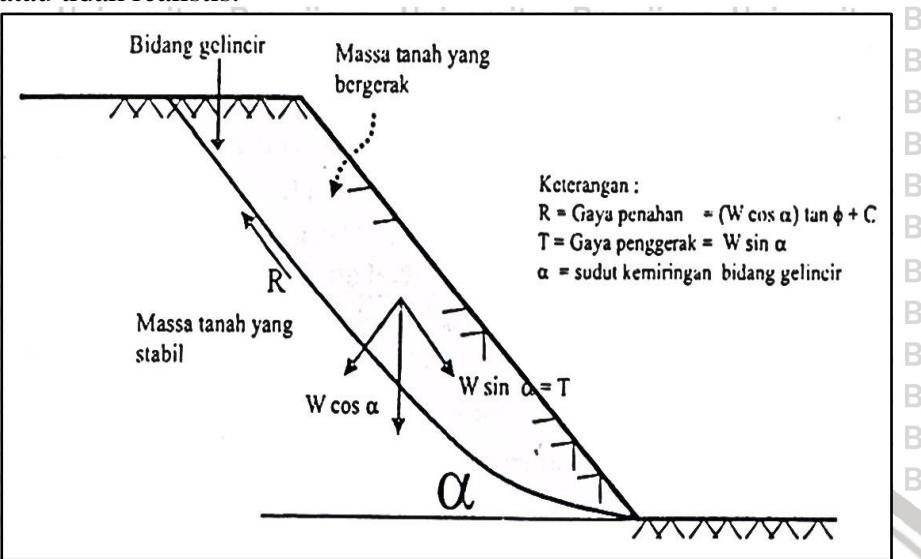
Gambar 2.11 Gaya-gaya yang Mengontrol Kestabilan Suatu Lereng
