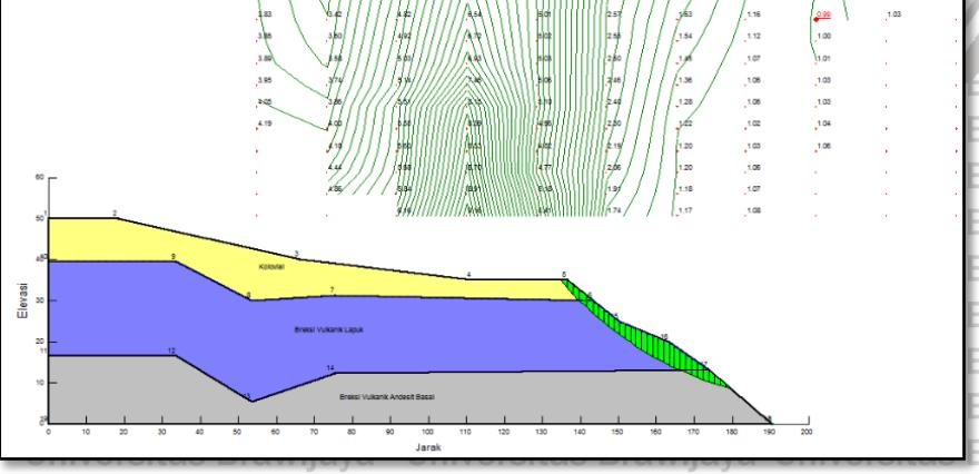
**Gambar 4.10.** Analisis Faktor Keamanan Lereng pada Kondisi Tanpa Gempa Kelongsoran pada Cross STA 0+175
