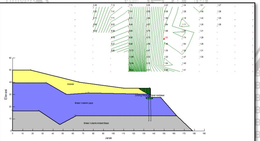
Gambar 4.37. Nilai Analisis Faktor Keamanan Lereng Alternatif 3 Dinding Penahan Tanah Kantilever Dengan *Bored Pile* Pada Kondisi Tanpa Gempa
