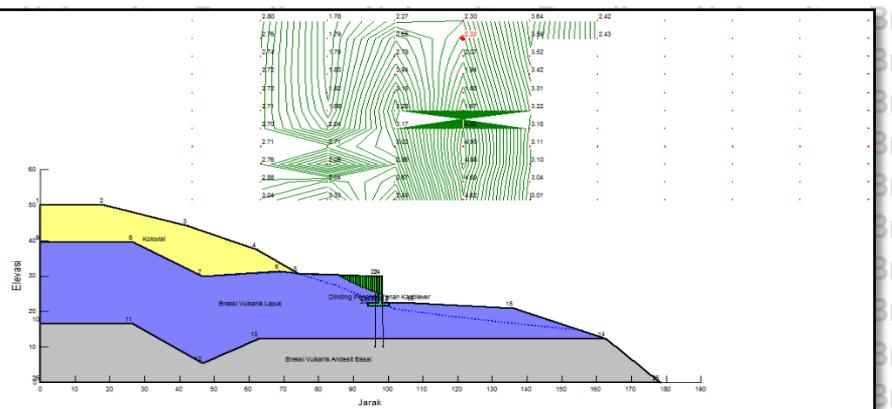
**Gambar 4.26.** Nilai Analisis Faktor Keamanan Lereng Alternatif 3 Dinding Penahan Tanah Kantilever Dengan *Bored Pile* Pada Kondisi Tanpa Gempa
