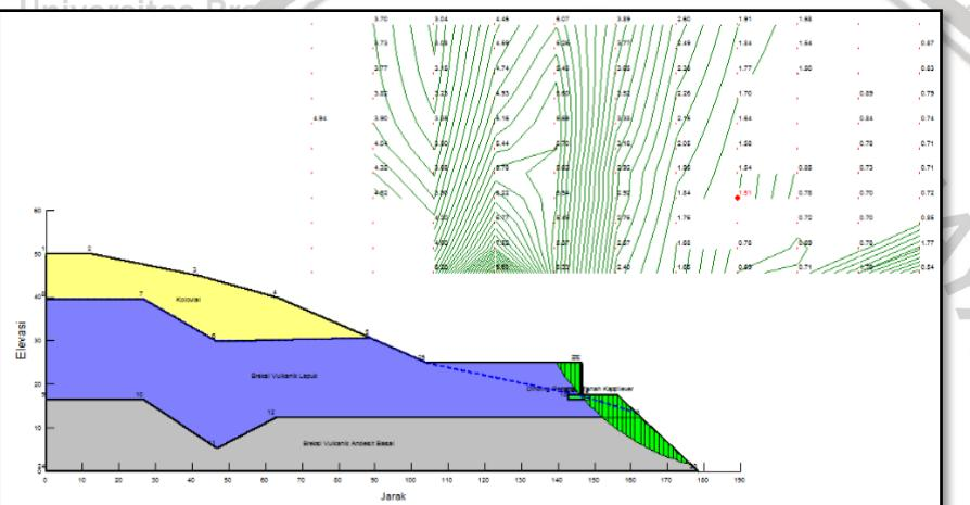
*Gambar 4.15.* Nilai Analisis Faktor Keamanan Lereng Alternatif 2 Dinding Penahan Tanah Kantilever Pada Kondisi Tanpa Gempa
