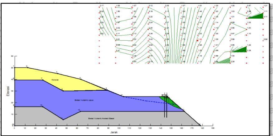
Gambar 4.19. Nilai Analisis Faktor Keamanan Lereng Alternatif 1 *Bored Pile* Pada Kondisitas Brawijaya
