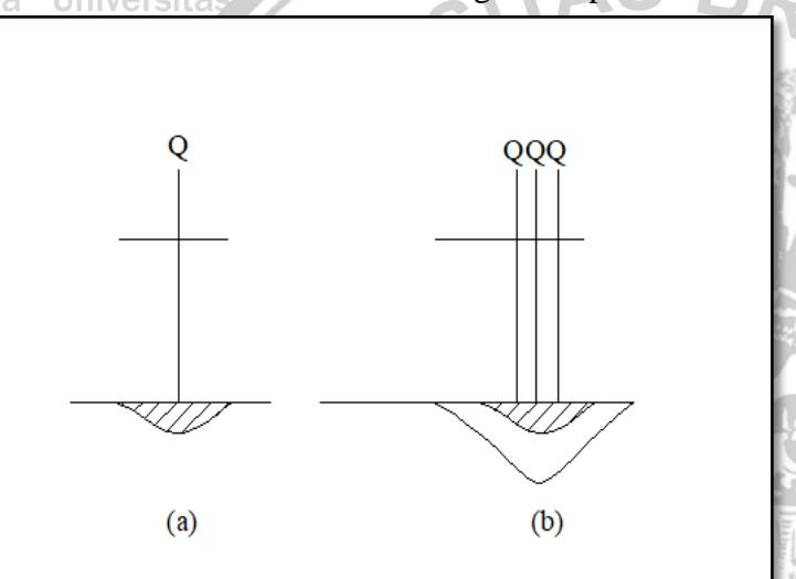
Gambar 2.22 Distribusi Tekanan Pada Tanah di Bawah Tiang
