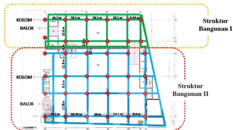
Gambar 4.32 Pembagian struktur Mal Mitra 2
