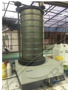
Sieve shaker (penyaringan sampel sedimen)
