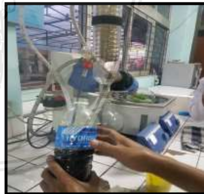
Evaporasi menggunakan alat Vacuum Rotary Evaporator
