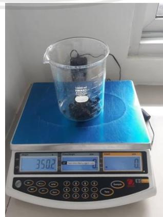
Gambar 23. Perhitungan Total Padatan (Mikroplastik dan Bahan-Bahan Alami)
