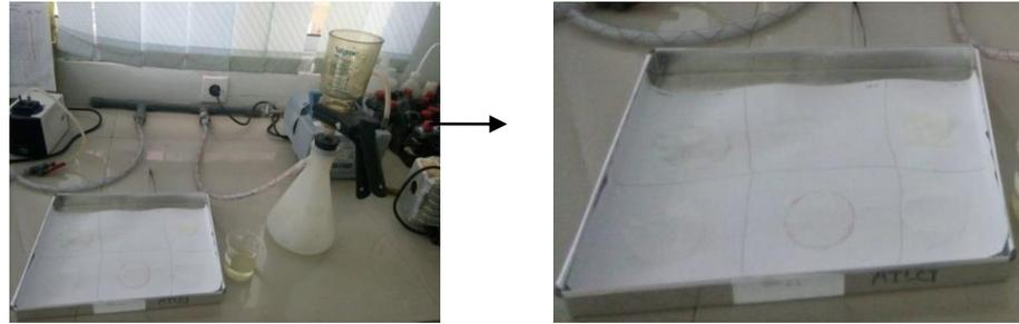
Gambar 17. Penyaringan Mikroplastik Sampel Sedimen Pantai
