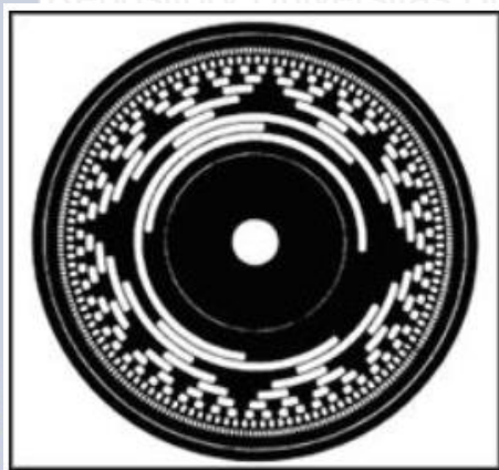
Gambar 2.8 Susunan pola 16 cincin konsentris pada absolut encoder Sumber : Rizqiawan (2009)
