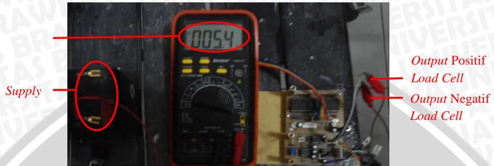
Gambar 4.2. Pengujian Sensor *Load Cell* Dengan Beban 105 kg.
