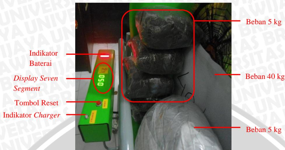
Gambar 4.21. Pengujian Dengan Beban 50 kg.
