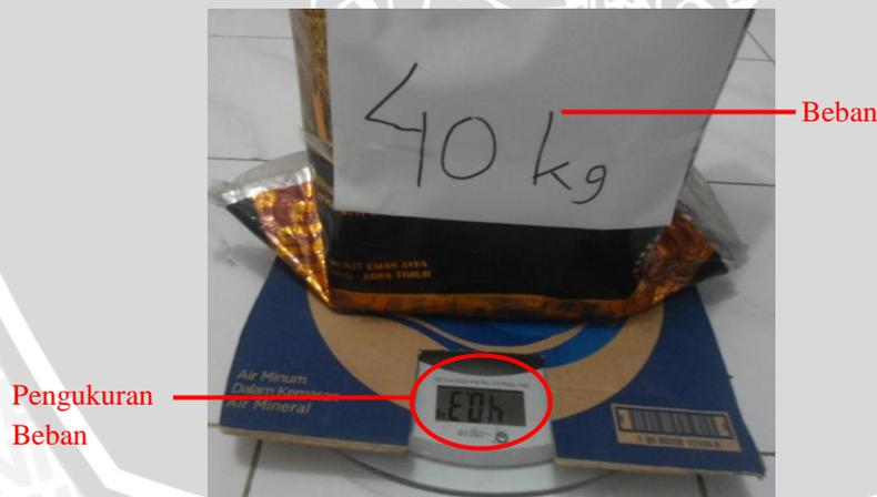
Gambar 4.14. Pengukuran Beban 40 kg Pada Kalibrator.
