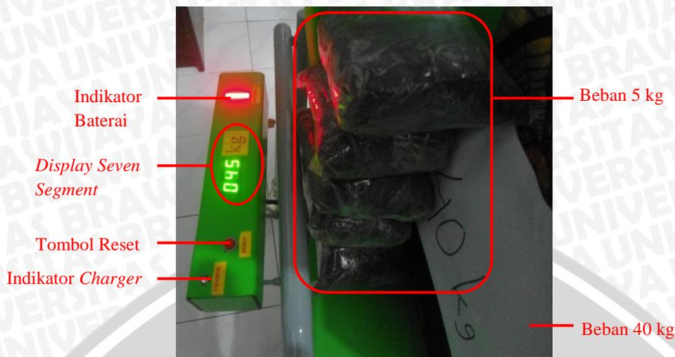
Gambar 4.20. Pengujian Dengan Beban 45 kg.
