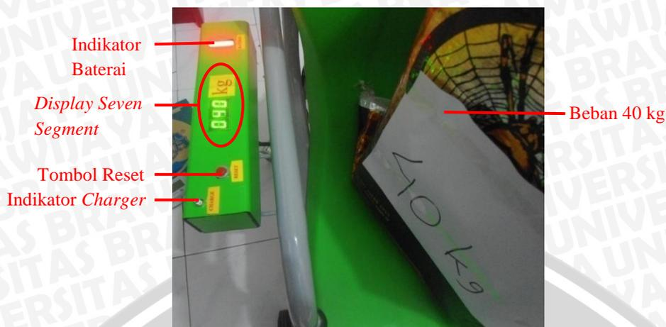
Gambar 4.15. Pengujian Dengan Beban 40 kg.
