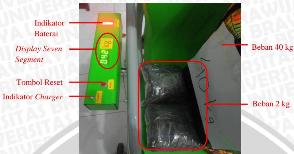
Gambar 4.17. Pengujian Dengan Beban 42 kg.
