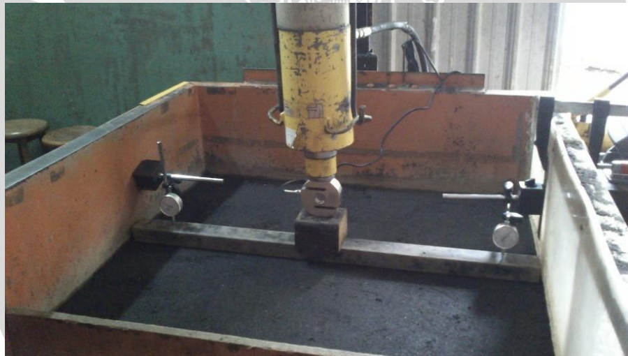
Gambar 4. 11 kondisi perletakan pondasi untuk pengujian pondasi di tanah datar pada saat percobaan
