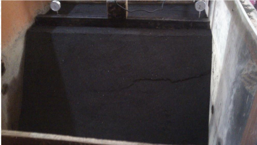
Gambar 4. 8 Keruntuhan yang terjadi saat percobaan
