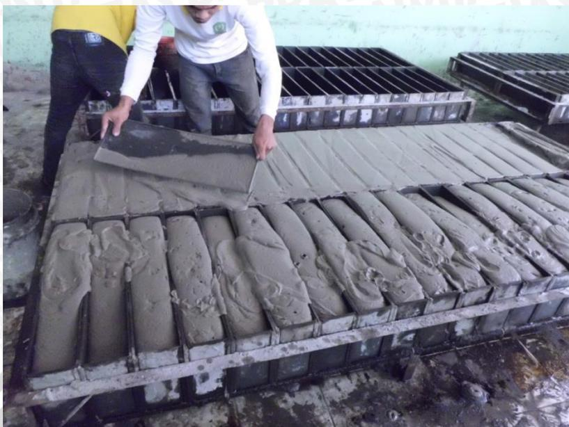
**Gambar. Pencetakan Benda Uji**
