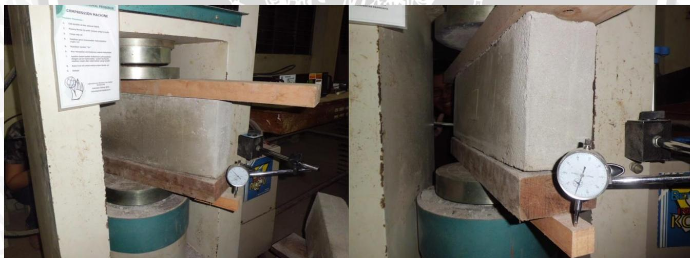
**Gambar. Pengujian Kuat Tekan Benda Uji**
