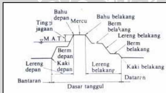
Gambar 2.9. Bentuk Standar dan Nama Bagian Tanggul
