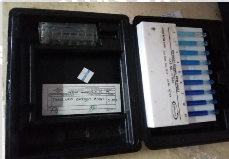
Gambar 12. Alat Pengukur DO
