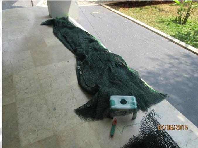
Gambar 24 . Pemasangan Badan Trawl dengan Kantong
