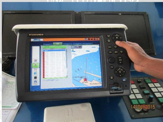
Gambar 41. Pembuatan Waypoint GPS Navnet
