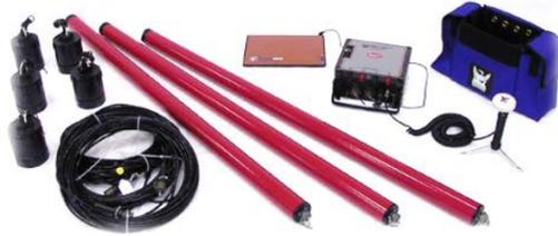
**Gambar 2.3** Seperangkat alat MTU Phoenix
