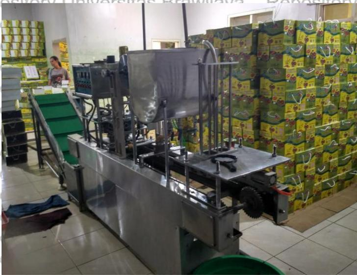
Mesin filling sekaligus sealer KSU Brosem dua cup
