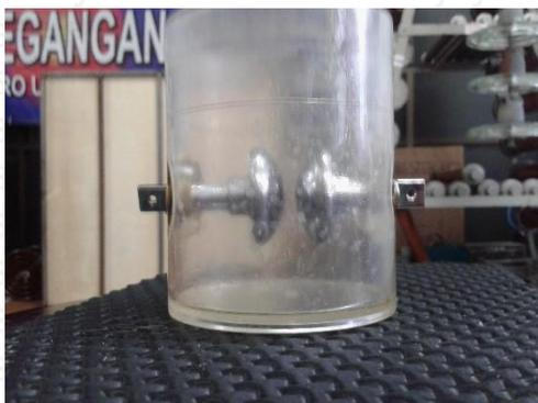
Gambar 3. 4 Wadah Uji dengan Elektroda standar VDE 370
