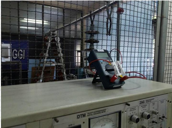
*Gambar L.5* Multimeter pada Pengujian Arus Bocor
