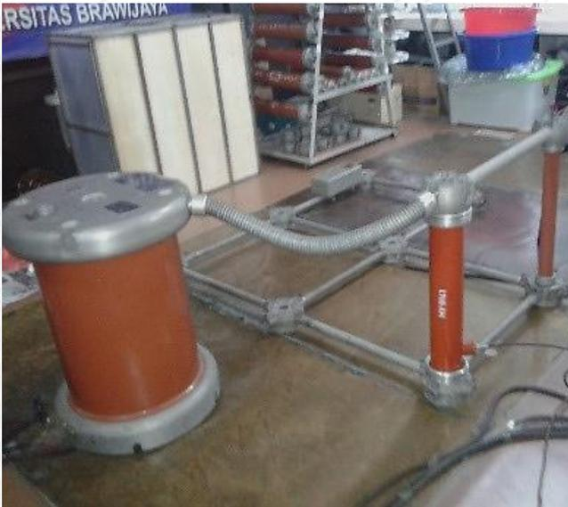
*Gambar L.7 Rangkaian Pengujian Tegangan Tinggi AC*
