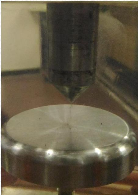
**Gambar L.11** Pengujian Arus Bocor Minyak Shell Diala B Murni Pada Elektroda Jarum Piring
