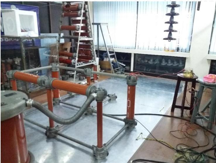
*Gambar L.8 Rangkaian Pengujian Tegangan Tinggi DC*
