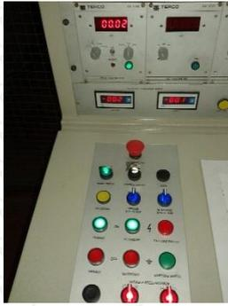
*Gambar L.4* Control Desk untuk Pengujian Tegangan Tinggi AC dan DC
