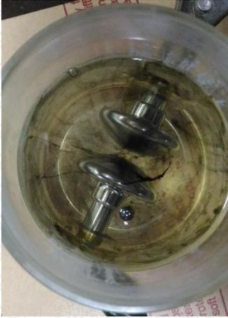
*Gambar 4. 1* Fenomena Karbon Setelah Pengujian Tegangan Tembus
