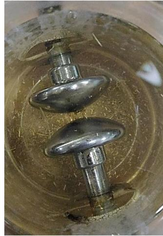
*Gambar 4. 4* Fenomena Jerami dalam Minyak Transformator Sesudah Pengujian Tegangan Tembus
