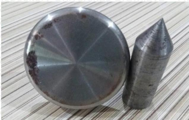
*Gambar L.6* Elektroda Jarum dan Piring yang Digunakan Dalam Pengujian
