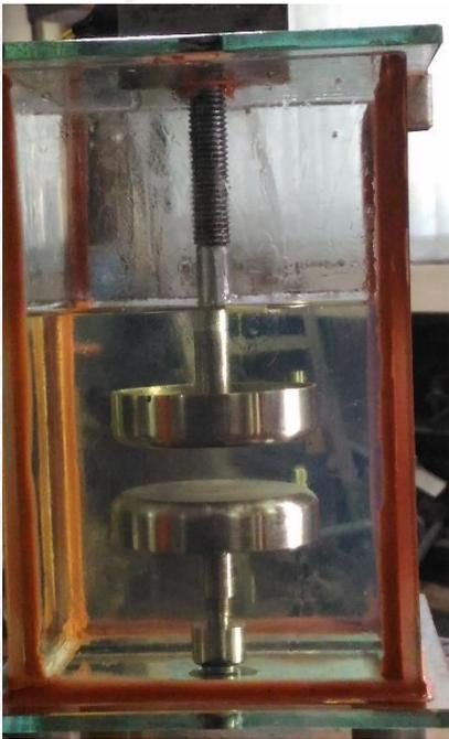
*Gambar L.12* Pengujian Arus Bocor Dalam Minyak Murni Pada Elektroda Piring-piring
