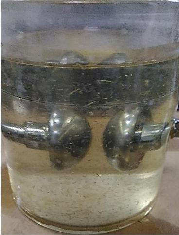
*Gambar 4. 3* Fenomena Jerami dalam Minyak Transformator Sebelum Pengujian Tegangan Tembus
