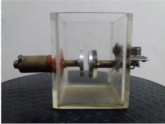
Gambar 3. 5 Tabung Uji dengan Elektroda Cincin Pengaman
