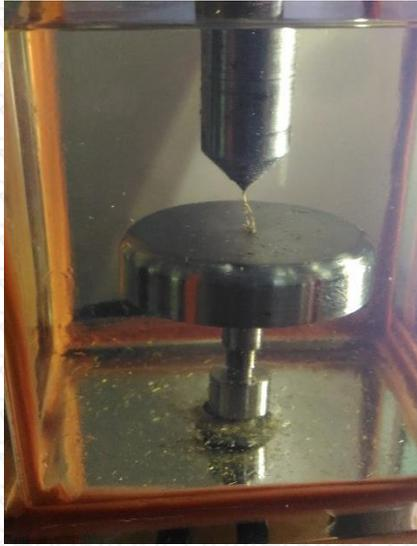
*Gambar L.14 Jembatan Jerami Saat Pengujian Arus Bocor Pada Elektroda Jarum Piring*
