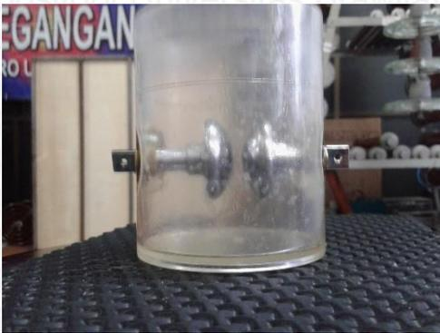
Gambar L.1 Tabung Uji dengan Elektroda Standar 2.5mm
