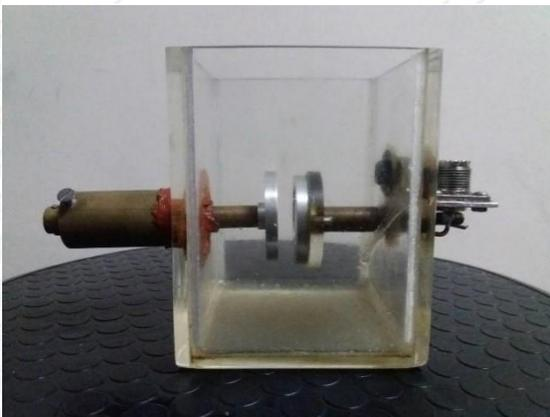
Gambar L.2 Tabung Uji dengan Elektroda Cincin
