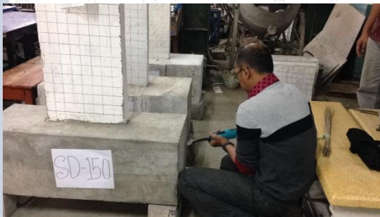
Pengujian Digital Hammer Test pada Dinding Geser
