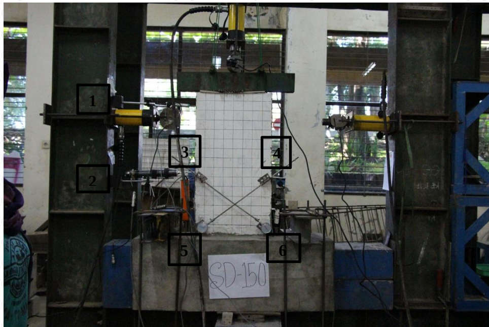
Pengujian Beban Siklik Benda Uji Dinding Geser
