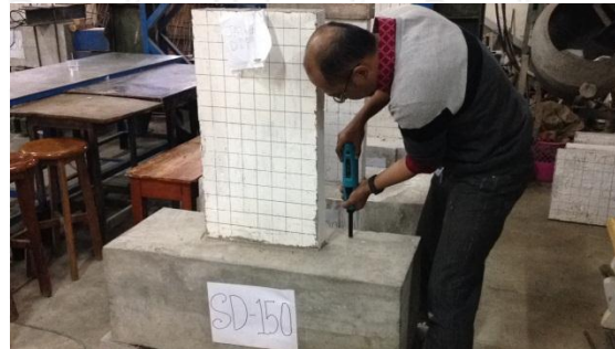
Pengujian Digital Hammer Test pada Dinding Geser
