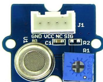
Gambar 2.3 Bentuk fisik sensor HCHO
