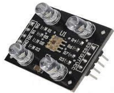
Gambar 2.2 Sensor warna TCS320
