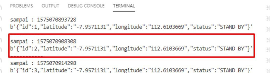
**Gambar 6. 44 Terminal pada *Subscriber* Menampilkan Waktu dalam *Milliseconds***
