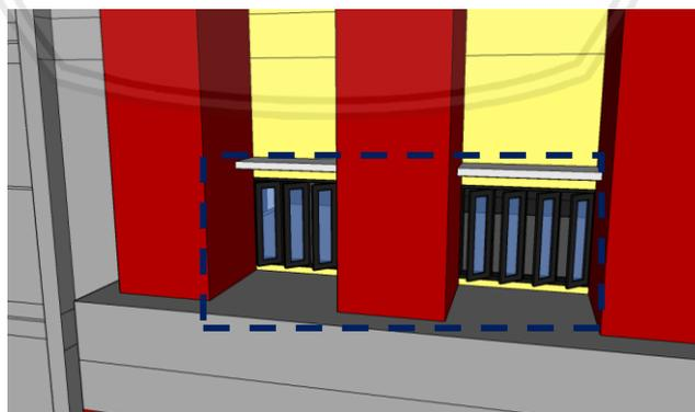
Gambar 4.58 Penambahan jendela casement side-hang pada kelas tipe B lantai 3
