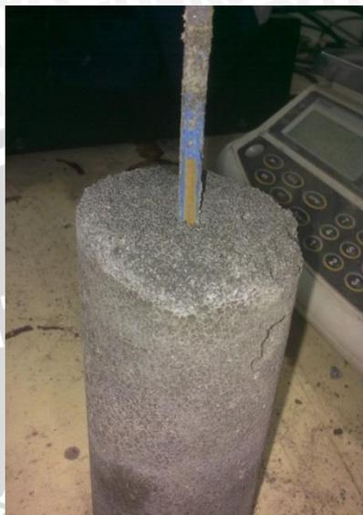
**Gambar 4.11** Selip yang Terjadi pada Benda Uji *Pull Out*
