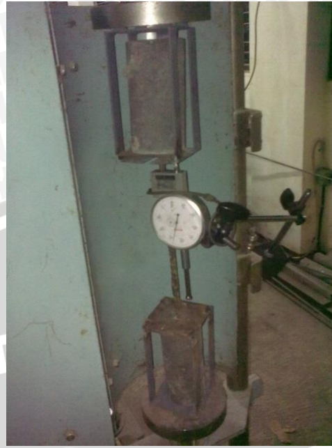
Pengujian Pull Out
