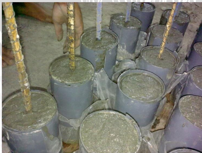
Pencetakan Benda Uji
