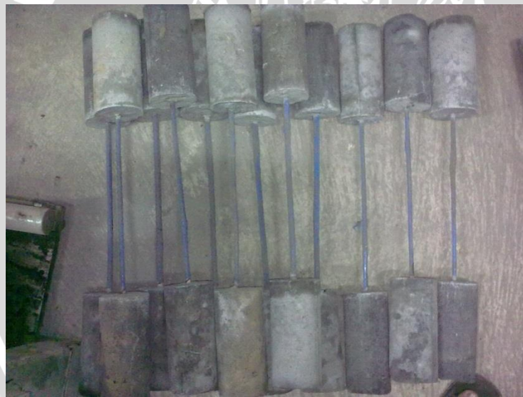
Benda Uji Pengujian Pull Out Siap Uji
