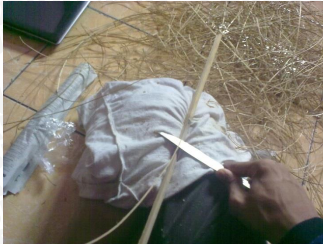
Pembuatan Tulangan Bambu
