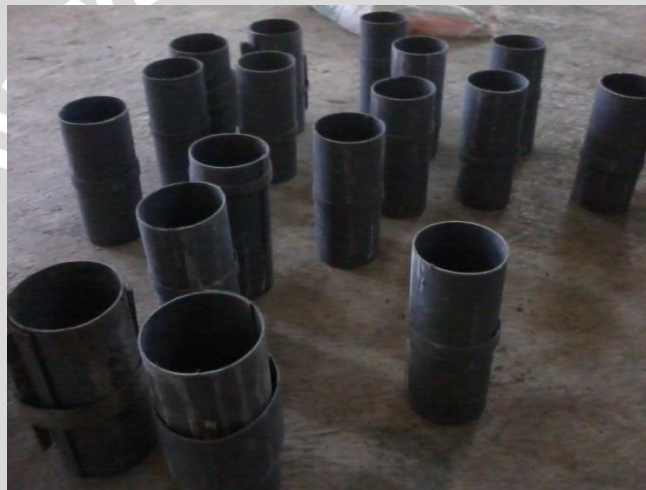
Cetakan Benda Uji Pull Out
