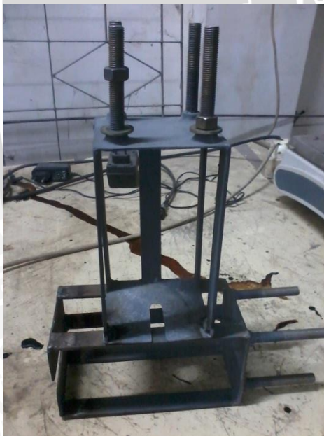
Alat Bantu Pengujian Pull Out
