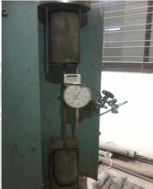
Gambar 4.2 Posisi dial gauge dan benda uji saat pengujian
