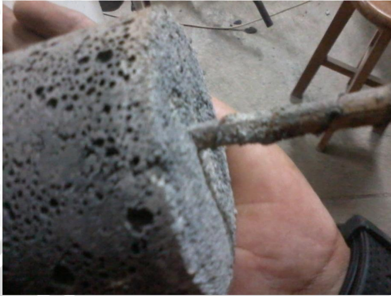
Gambar L.7 Selip yang terjadi akibat pengujian pull out
