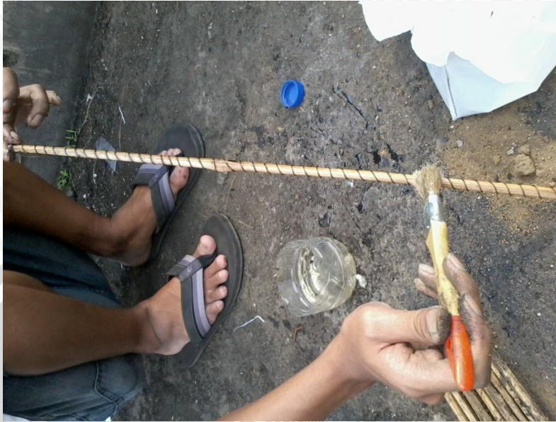
Gambar L.1 Pemberian lapisan melamin pada tulangan bambu
