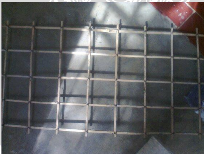
Gambar L.2 Rangkaian tulangan dalam panel
