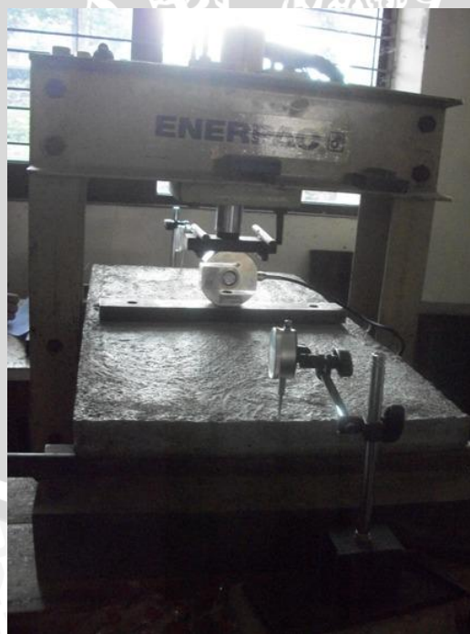
Gambar L.4 Pengujian kuat lentur panel
