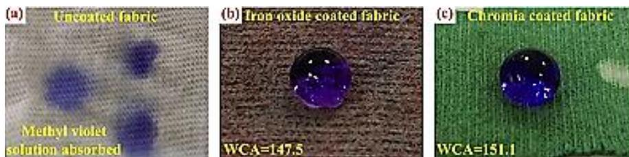
Gambar 2.20 uji dengan tetesan Methyl violet pada (a) kain tidak dilapisi; (b) kain dilapisi Besi-oksida dan (c) kain dilapisi Kromia.
