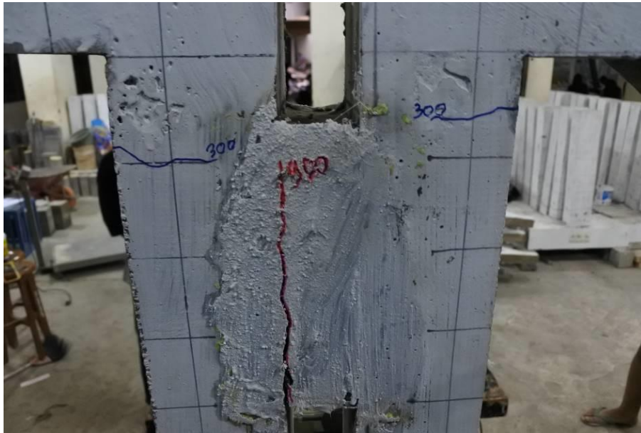
Gambar 4.25 Pola Retak pada Kuda-Kuda Tipe B Pembebanan Vertikal Tidak Simetris
