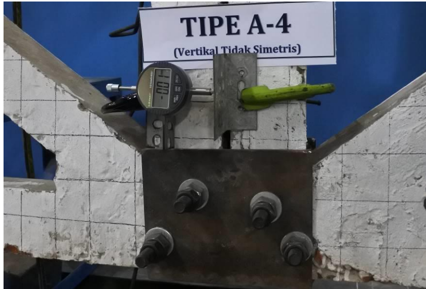
Gambar 4.12 Penempatan LVDT dititik C secara horizontal kuda-kuda tipe A
