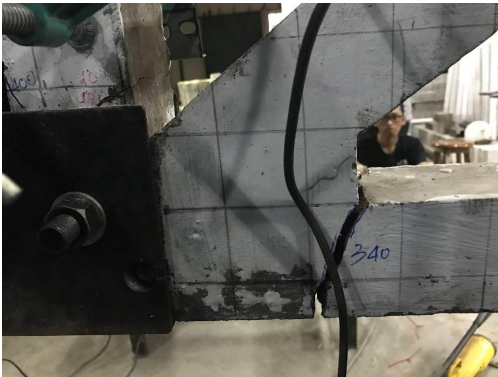
Gambar 4.24 Pola Retak pada Kuda-Kuda Tipe A Pembebanan Vertikal Simetris
