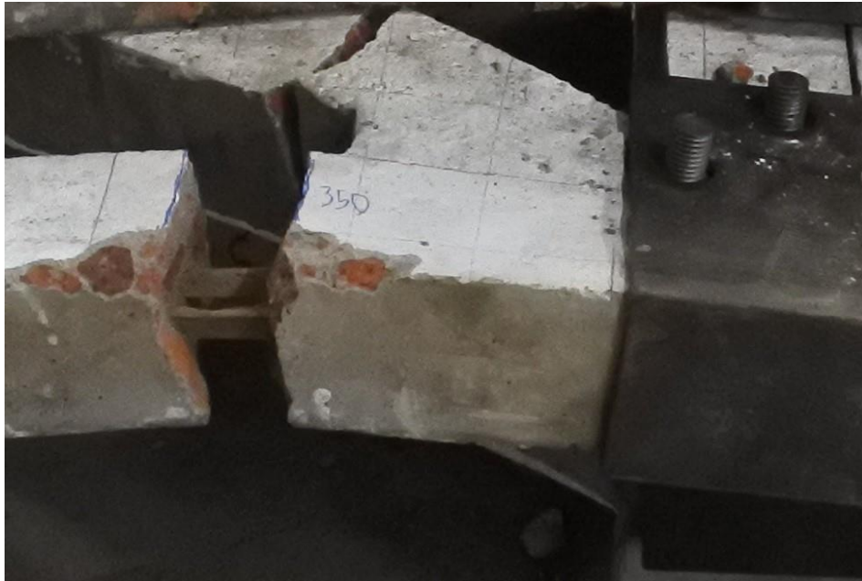
Gambar 4.27 Kondisi terakhir retakan pada kuda-kuda Tipe A
