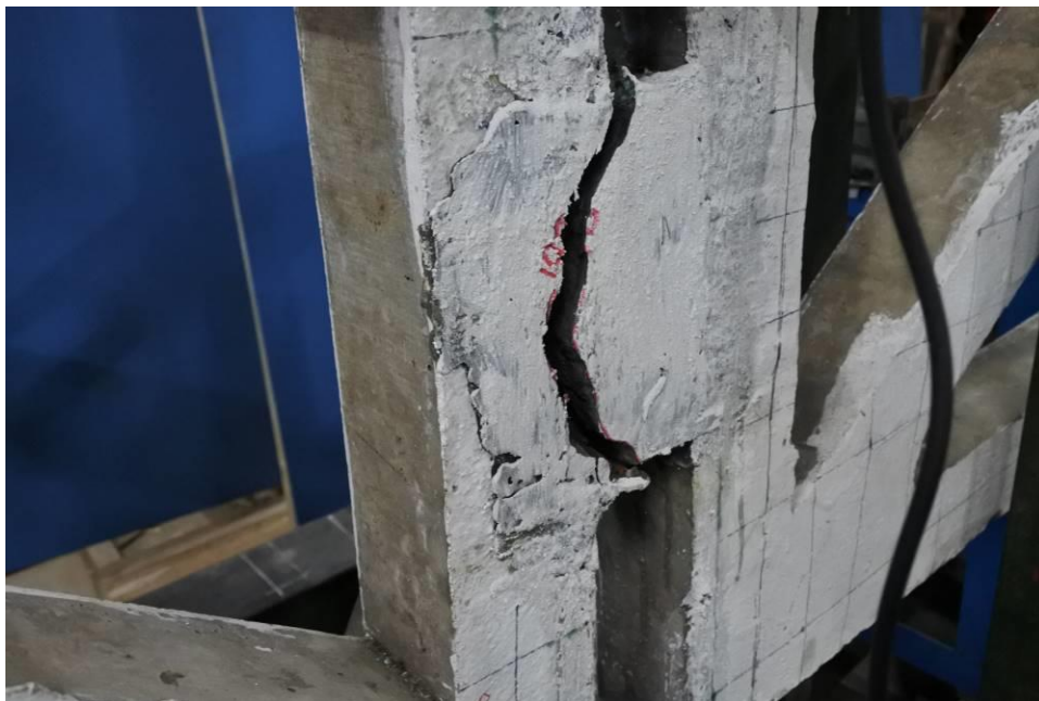
Gambar 4.26 Pola Retak pada Kuda-Kuda Tipe B Pembebanan Vertikal Simetris
