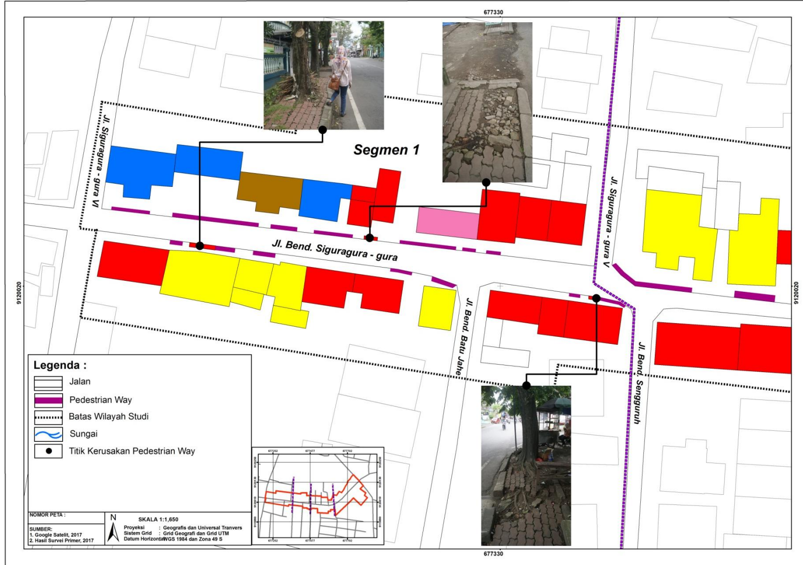
Gambar 4.3 Peta Titik Kerusakan Jalur Pejalan Kaki Segmen 1
