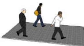
Gambar 2.13 Kondisi Pedestrian Tingkat Pelayanan LOS C
