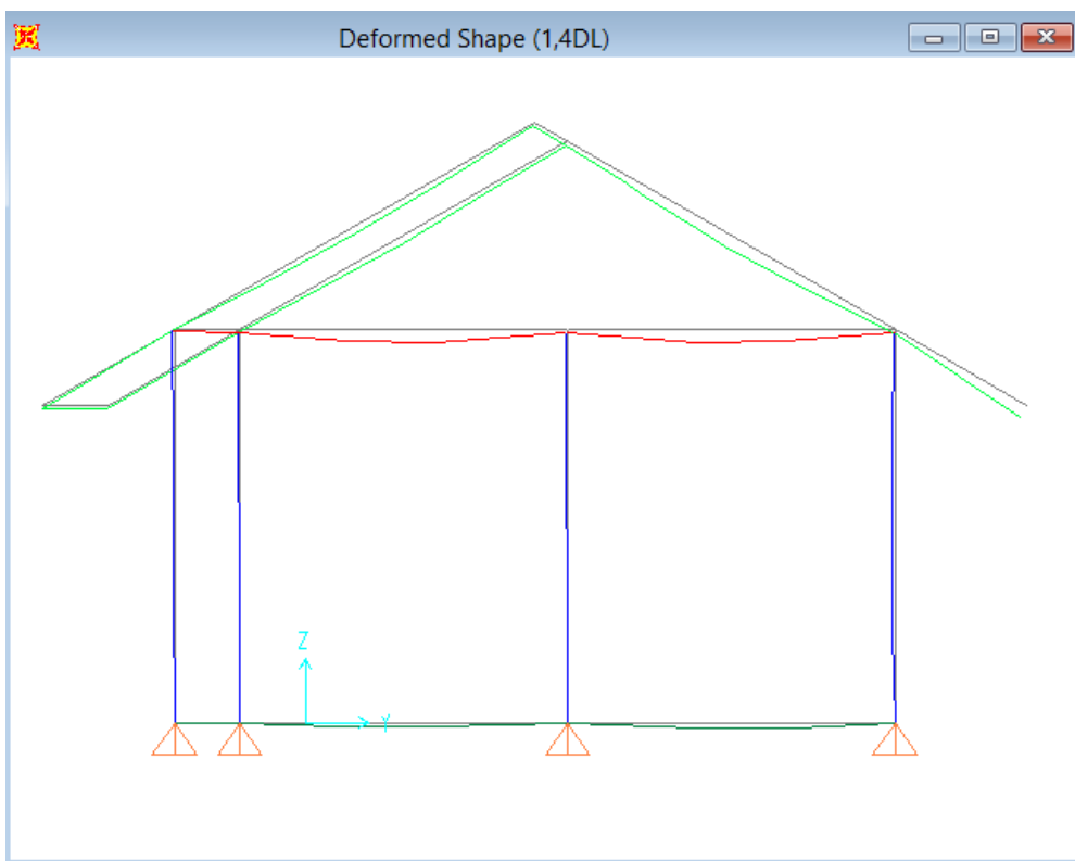
Gambar Lampiran 1.2 Perpindahan titik (cm) pada dinding pasangan bata merah buatan tangan
