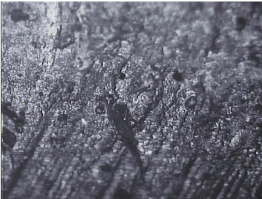
Gambar foto mikrostruktur Depth of Cut 3,5 mm dan Rasio L/D=6
