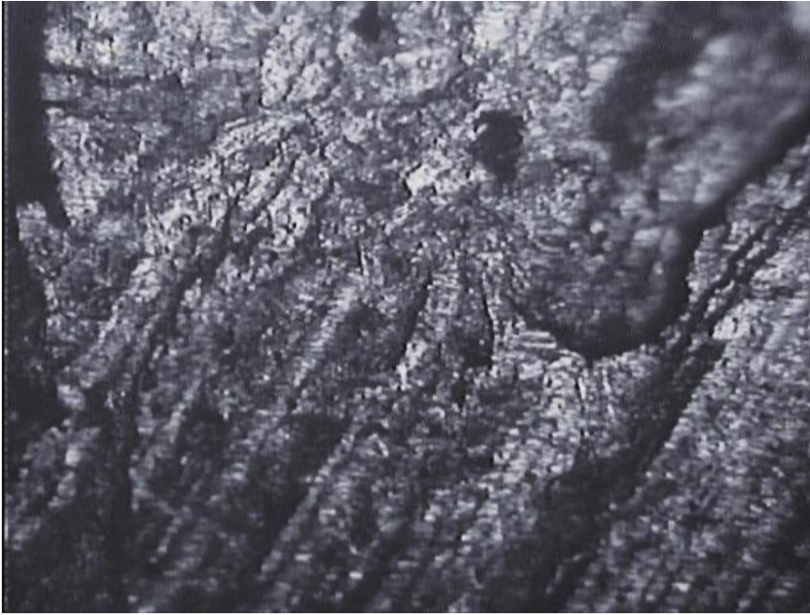
Gambar foto mikrostruktur Depth of Cut 4 mm dan Rasio L/D=5
