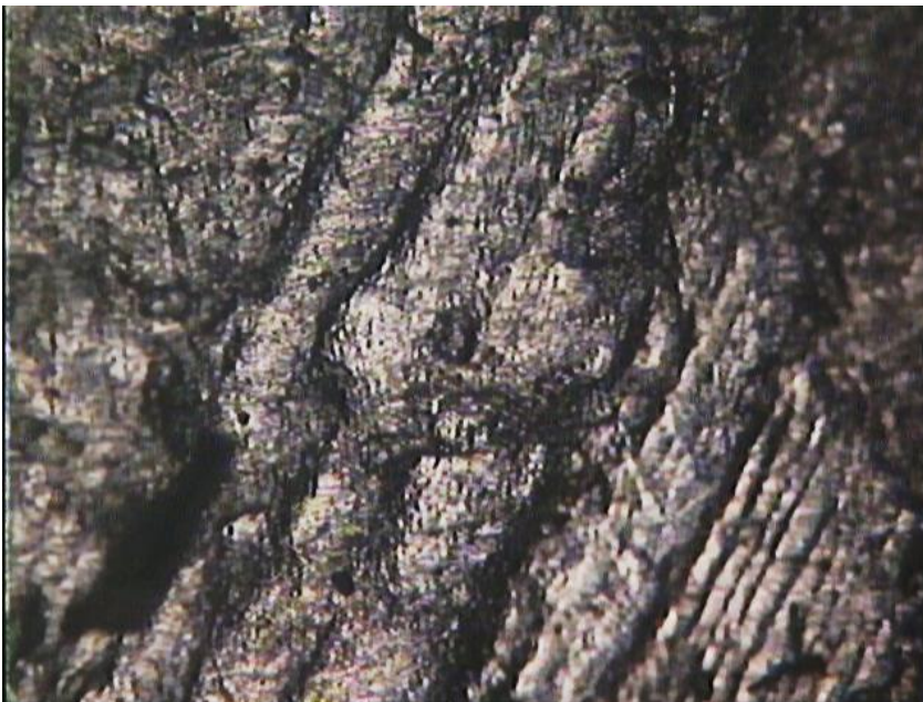
Gambar foto mikrostruktur Depth of Cut 3 mm dan Rasio L/D=6
