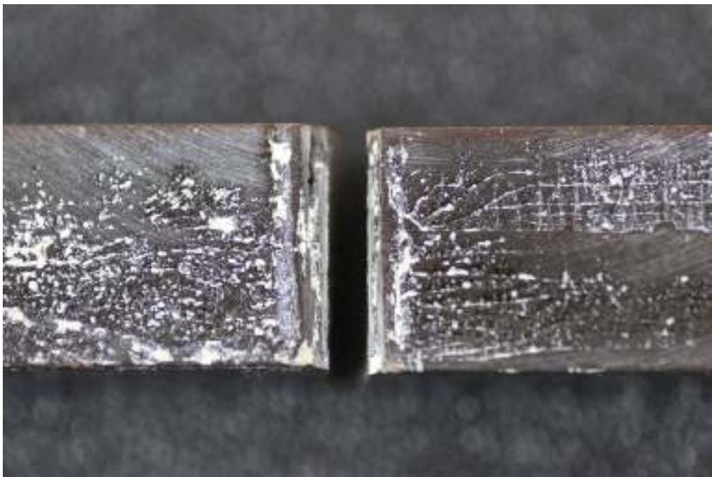
Spesimen dengan ukuran filler 125 μm perbesaran 4x.
