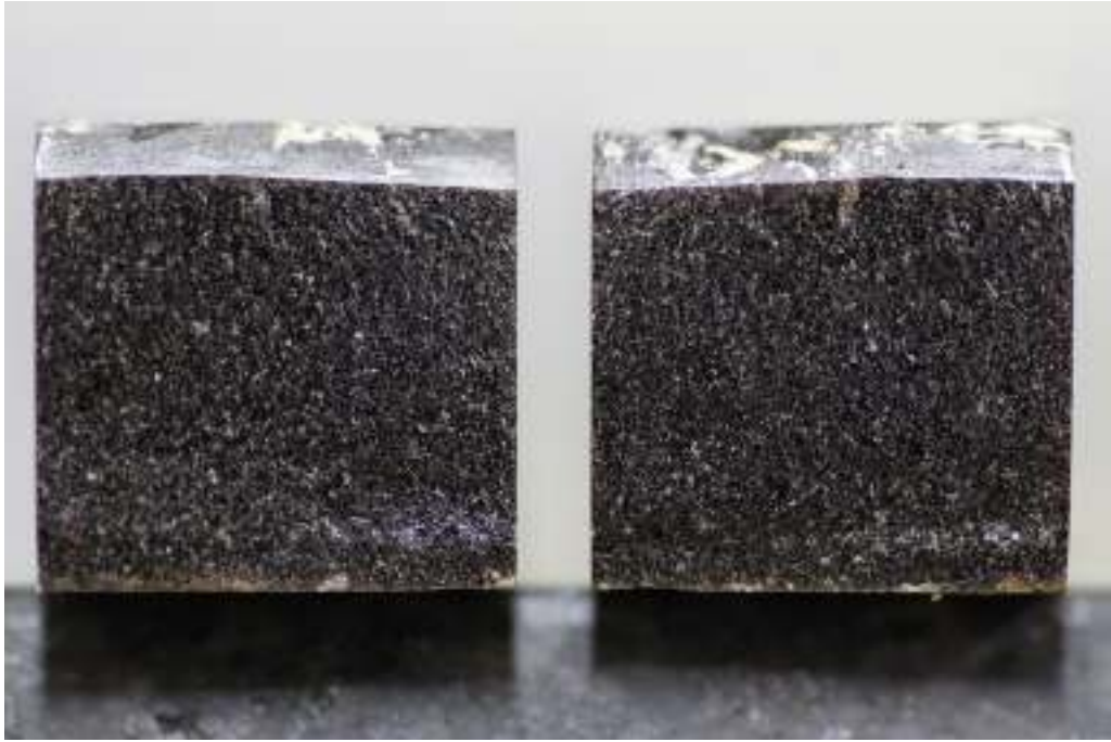
Spesimen dengan ukuran filler 140 \mu\text{m} perbesaran 5x.
