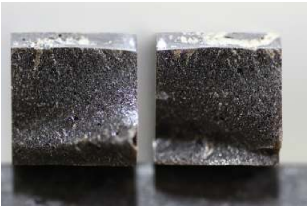
Spesimen dengan ukuran filler 125 \mu\text{m} perbesaran 5x.
