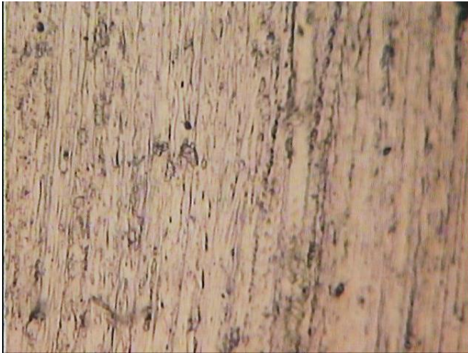
Foto mikro benda kerja hasil proses End Milling Dengan Variasi Depth of cut 100 mm dengan menggunakan magnet
