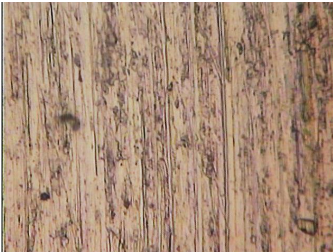
Foto mikro benda kerja hasil proses End Milling Dengan Variasi Depth of cut 100 mm tanpa menggunakan magnet
