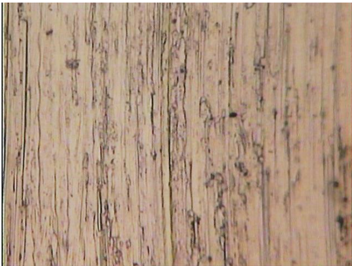
Foto mikro benda kerja hasil proses End Milling Dengan Variasi Depth of cut 50 mm tanpa menggunakan magnet
