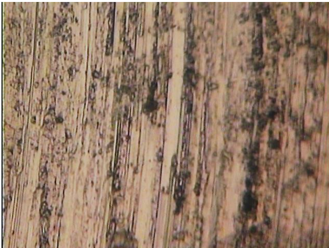
Foto mikro benda kerja hasil proses End Milling Dengan Variasi Depth of cut 150 mm tanpa menggunakan magnet
