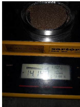
Proses pengujian kadar air serbuk kayu
