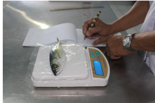
Pengukuran berat ikan menggunakan timbangan digital ( 500 \pm 0,5 g)
