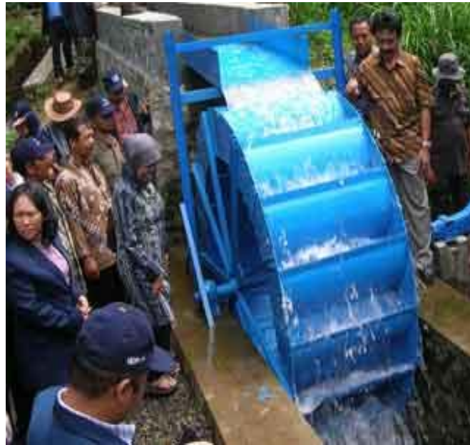
Gambar 1.2: PLTMH sederhana dengan penggerak kincir air
