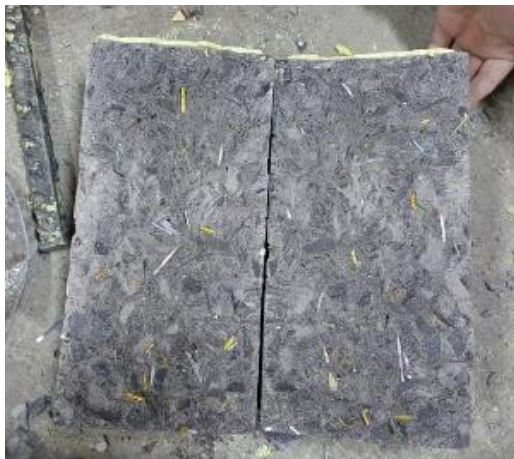
Gambar 4.5 Ujung serat kaleng terlihat masih utuh setelah diuji kuat tarik belah Sumber : Hasil Penelitian
