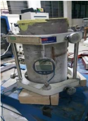
Gambar 4.17 Uji modulus elastisitas dengan menggunakan strain gauge Sumber: Dokumentasi Penelitian
