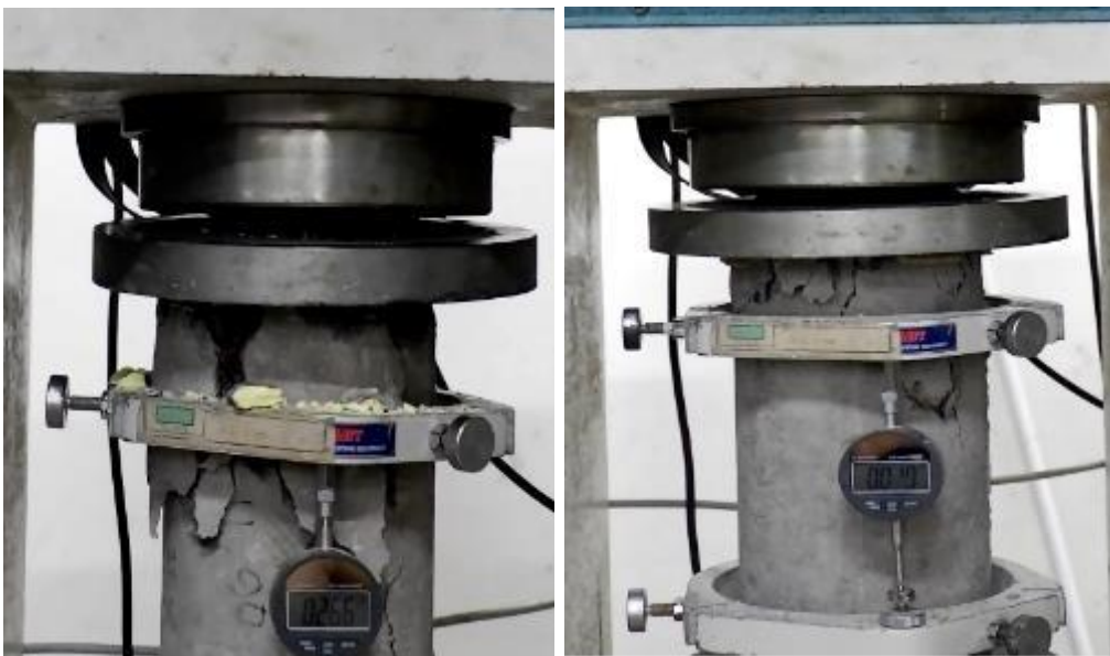
Gambar 4.9 Model kehancuran kuat tekan beton normal pumice dan beton serat fraksi 20% Sumber : Hasil Penelitian
