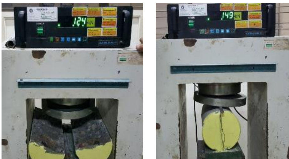
Gambar 4.6 Model kehancuran tarik belah beton normal dan beton serat fraksi 10% Sumber : Hasil Penelitian
