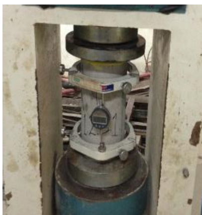
Gambar 2.8 Uji modulus elastisitas menggunakan extensometer
