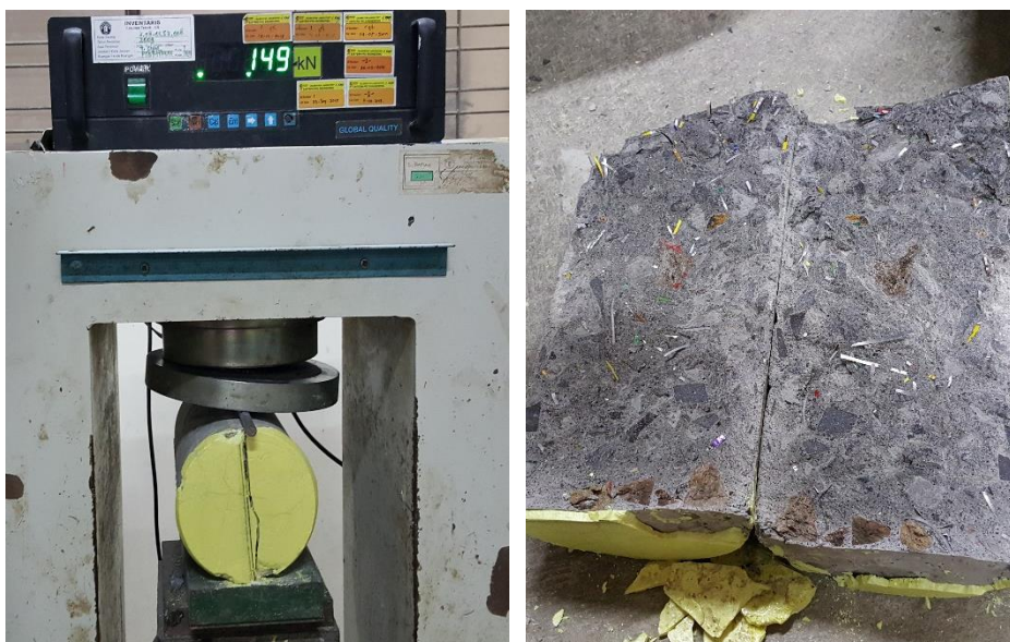
Gambar 4 Benda uji D.P.10%.1 (a) saat diuji kuat tarik belah (b) setelah diuji kuat tarik belah
