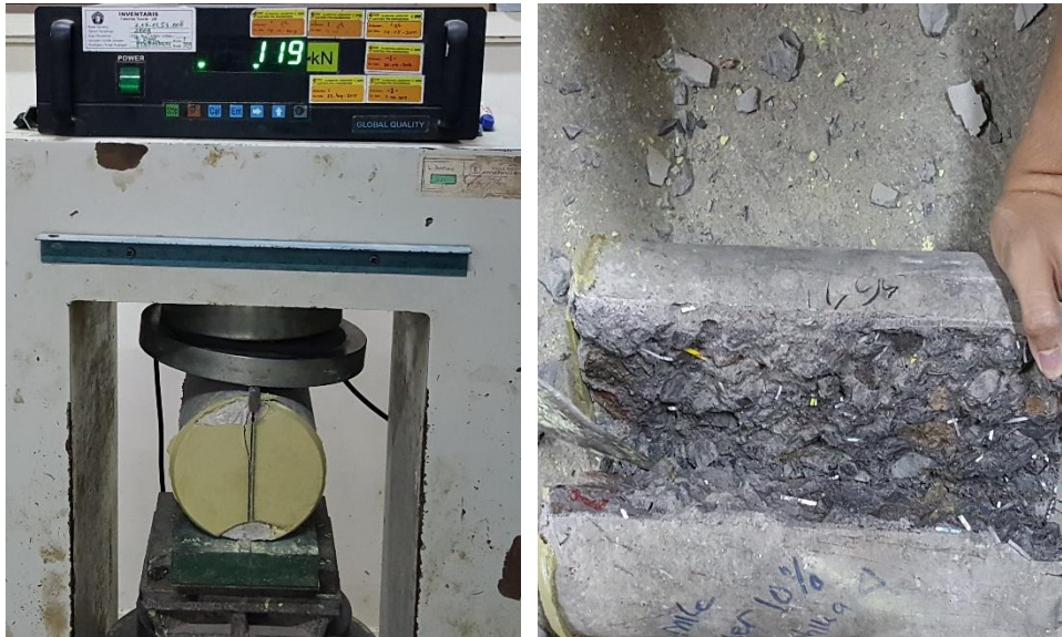
Gambar 5 Benda uji D.P.10%.2 (a) saat diuji kuat tarik belah (b) setelah diuji kuat tarik belah
