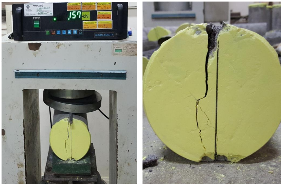
Gambar 6 Benda uji D.P.10%.3 (a) saat diuji kuat tarik belah (b) setelah diuji kuat tarik belah
