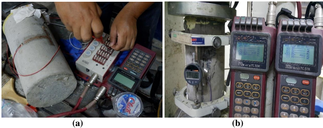
Gambar 1 Benda uji D.N.P.6 (a) Pemasangan alat strain gauge (b) Pembacaan dial strain gauge
