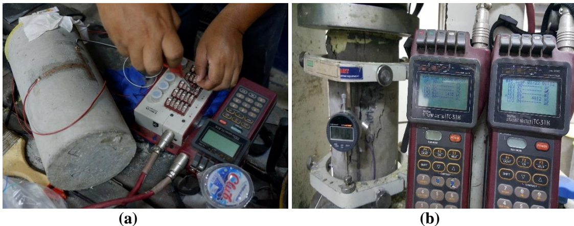
Gambar 3 Benda uji D.P.15%.6 (a) Pemasangan alat strain gauge (b) Pembacaan dial strain gauge Sumber : Dokumentasi Penelitian
