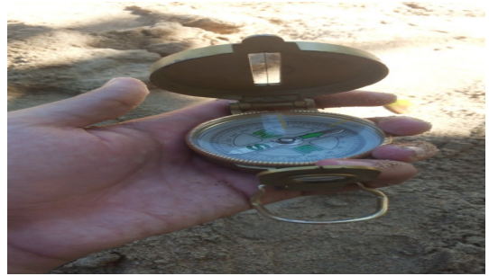
Kompas yang berfungsi untuk menentukan arah dalam pengambilan data gelombang
