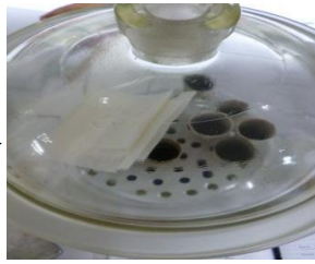
Pendinginan dalam desikator selama 15 menit
