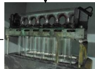
labu destruksi dipanaskan selama 2 jam dengan suhu 370^\circ\text{C}
