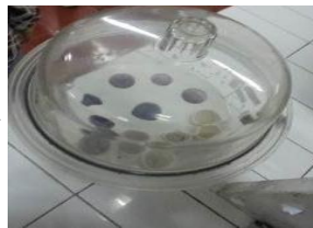
pendinginan dalam desikator selama 15 menit
