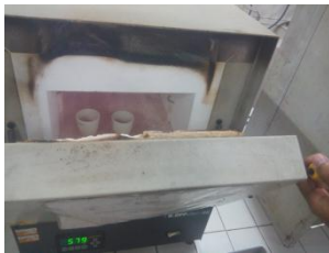
pengabuan dalam muffle pada suhu 600^{\circ}\text{C} dan diamati selama 15 menit hingga sampel berubah putih abu-abu
