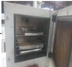
pengeringan dalam oven pada suhu 105^{\circ}\text{C} selama 5 jam
