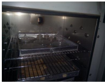
pengeringan cawan petri dan botol timbang dalam oven pada suhu 105^{\circ}\text{C} selama 24 jam
