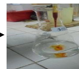
penambahan 1 tetes indikator metyl orange ke dalam erlenmeyer
