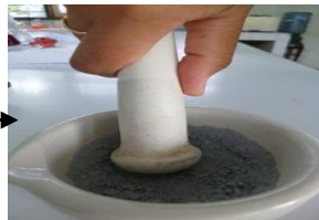
penghalusan tablet kjeldahl sebanyak 2 gram dengan mortar dan alu
