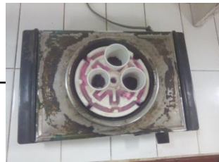
pengarangan di atas kompor listrik sampai tidak mengeluarkan asap
