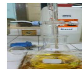
destilat dititrasi dengan \text{H}_2\text{SO}_4 0,3 N hingga berwarna merah muda
