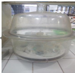
pendinginan dalam desikator selama 15 menit
