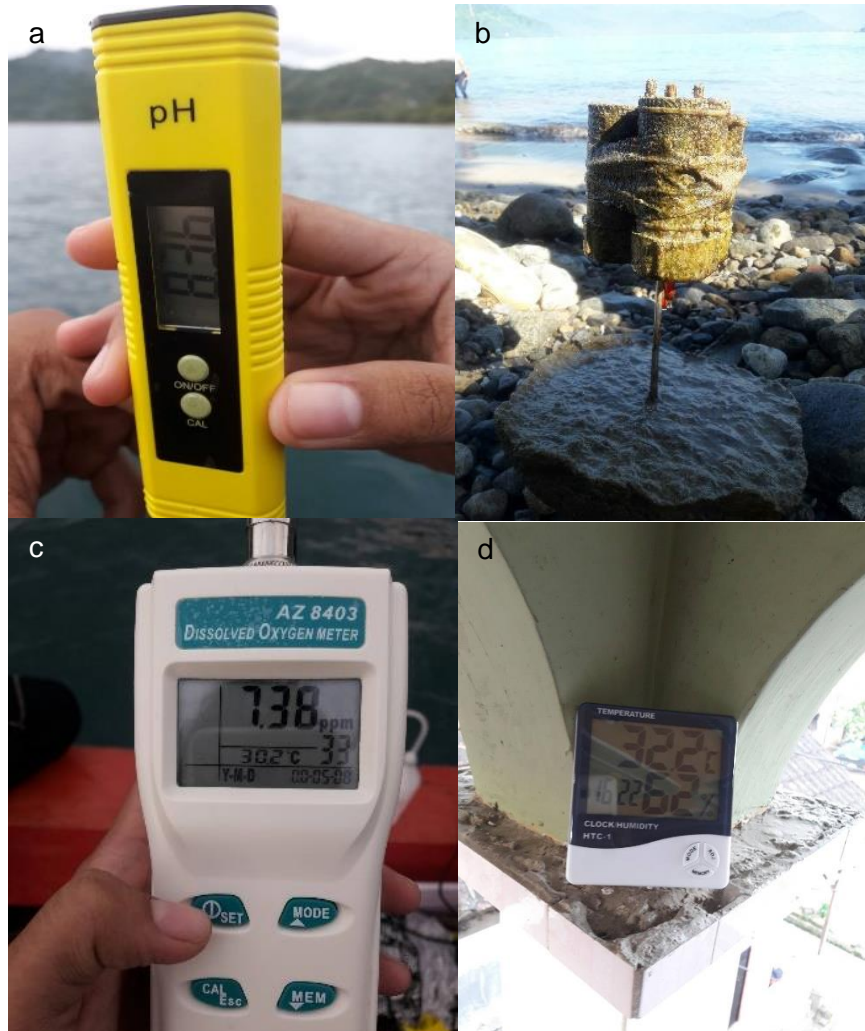
(a) pengambilan pH; (b) sedimen trap; (c) pengambilan DO; (d) humidity
